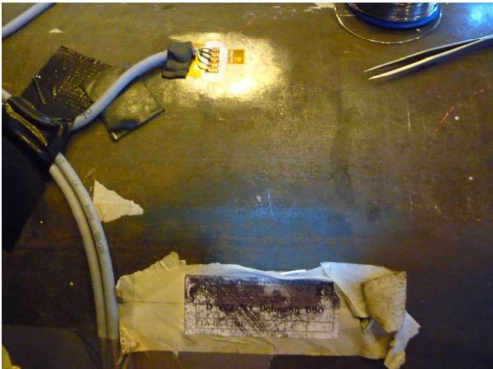
**Abbildung 4: DMS verkabelt und abgedeckt**
