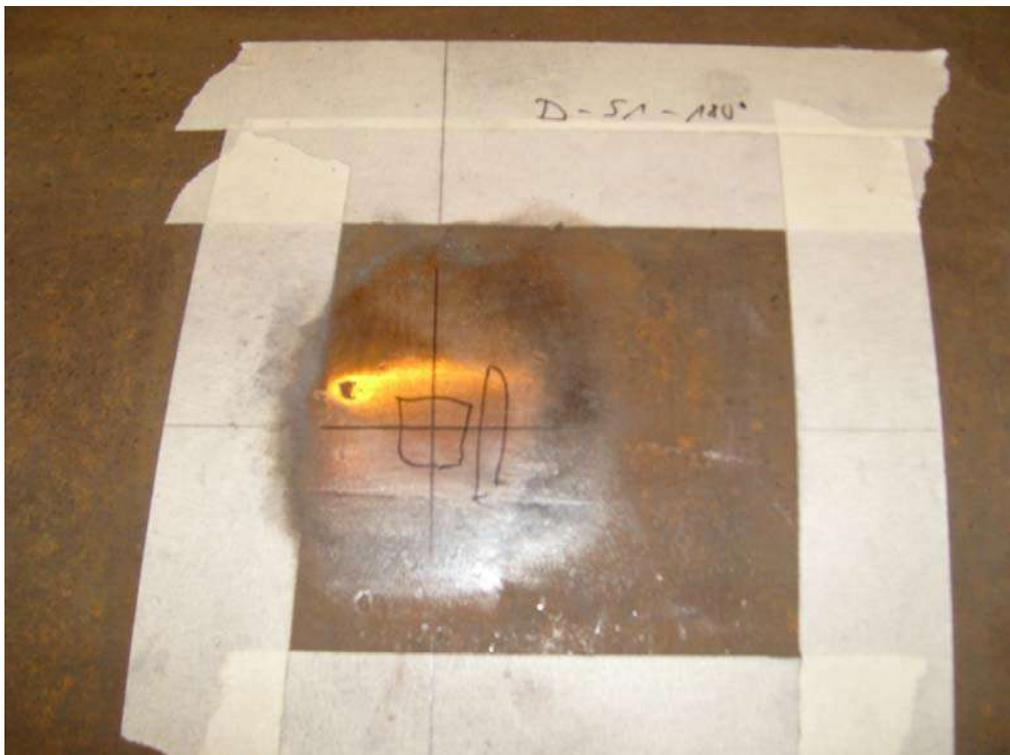
**Abbildung 2: DMS-Position angeschliffen**
