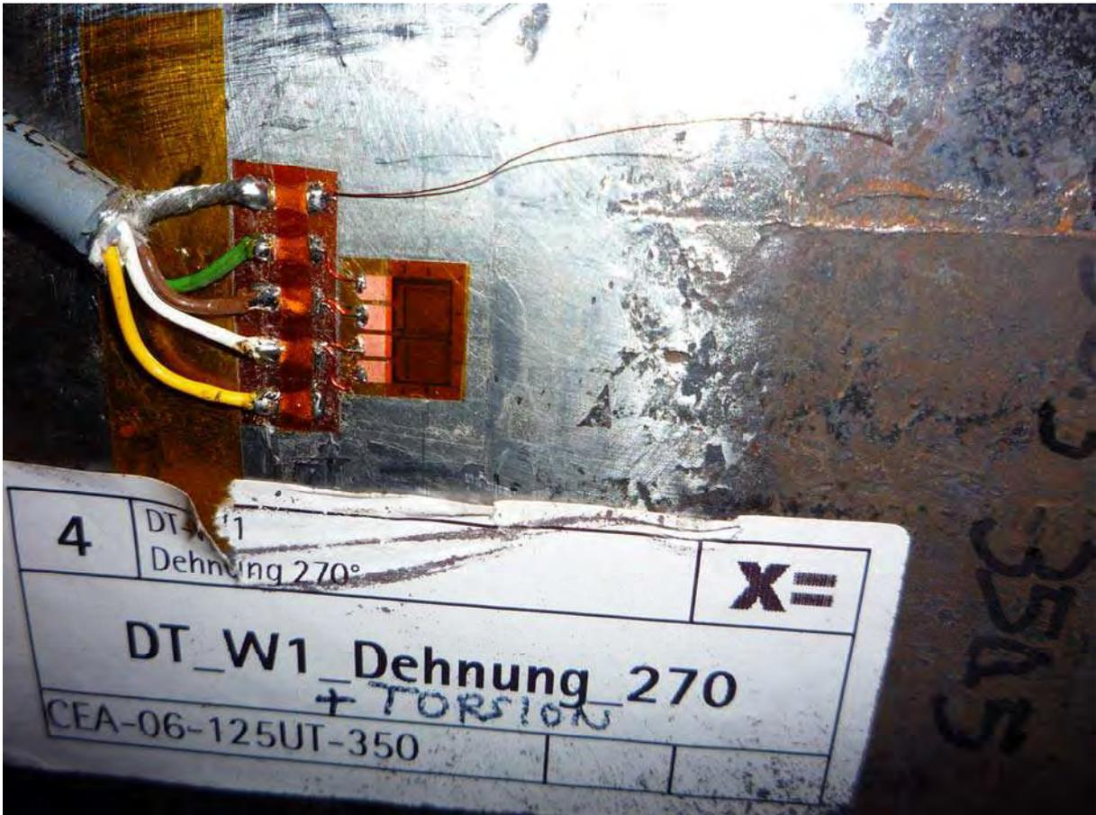
Abbildung 4: DMS verkabelt und abgedeckt
