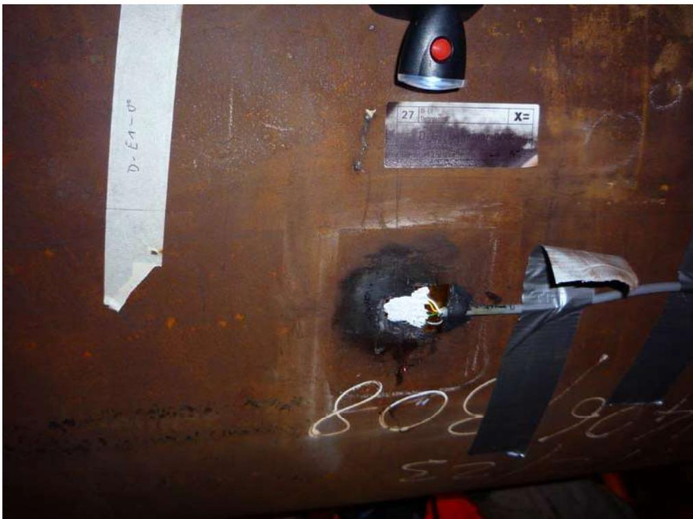
Abbildung 4: DMS verkabelt und abgedeckt
