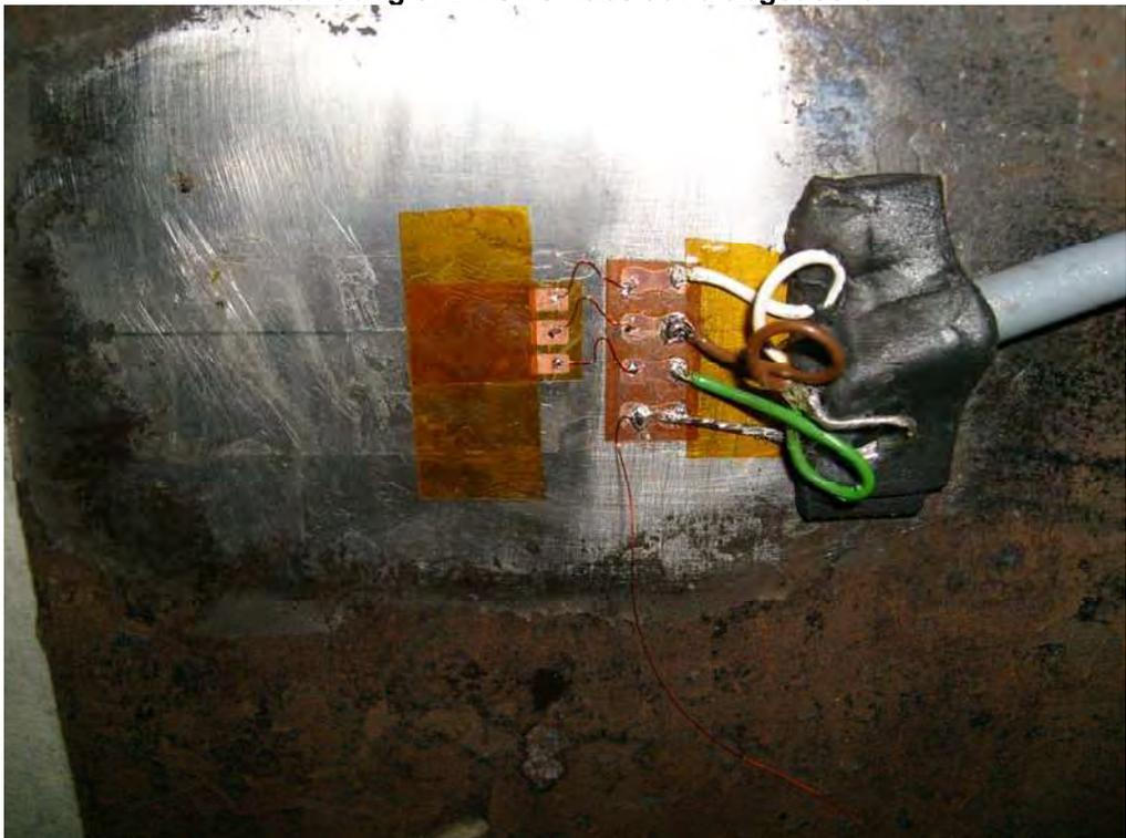
**Abbildung 6: DMS verkabelt und abgedeckt**
