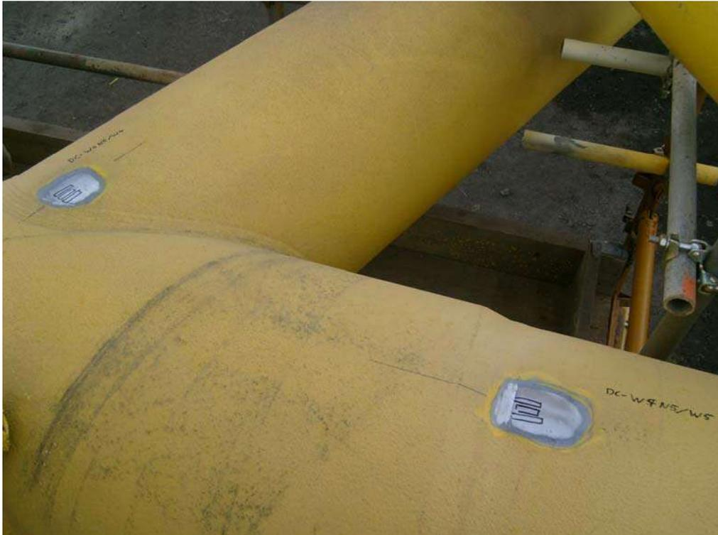
**Abbildung 1: DMS-Position angezeichnet und angeschliffen**
