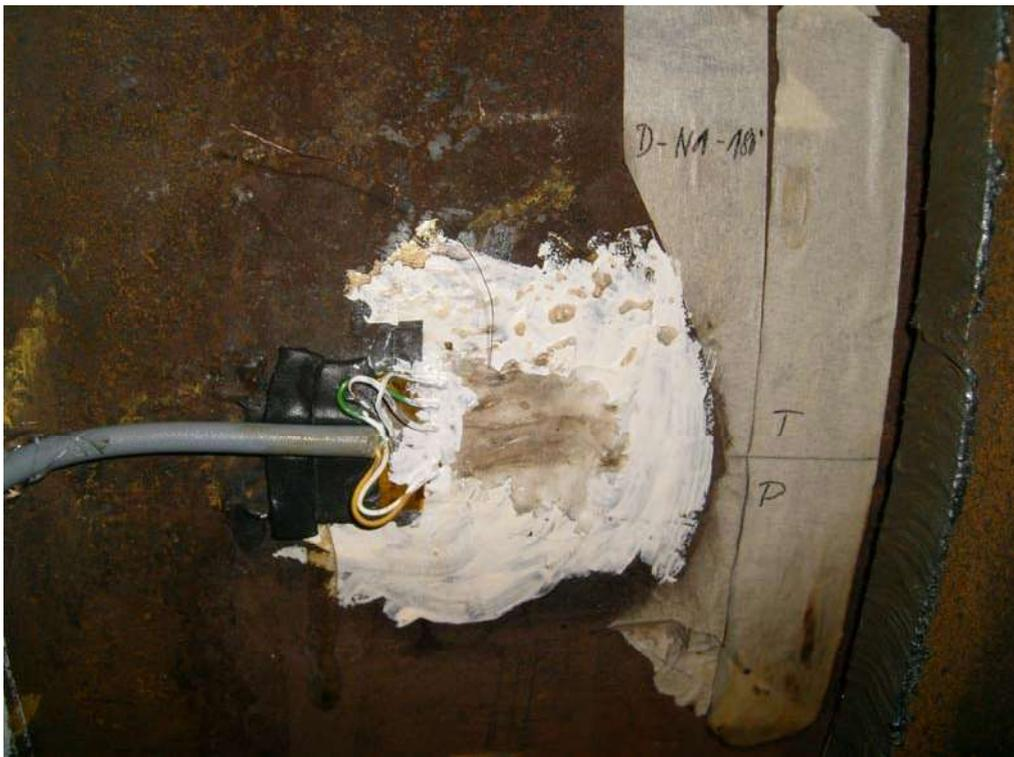
Abbildung 4: DMS verkabelt und abgedeckt
