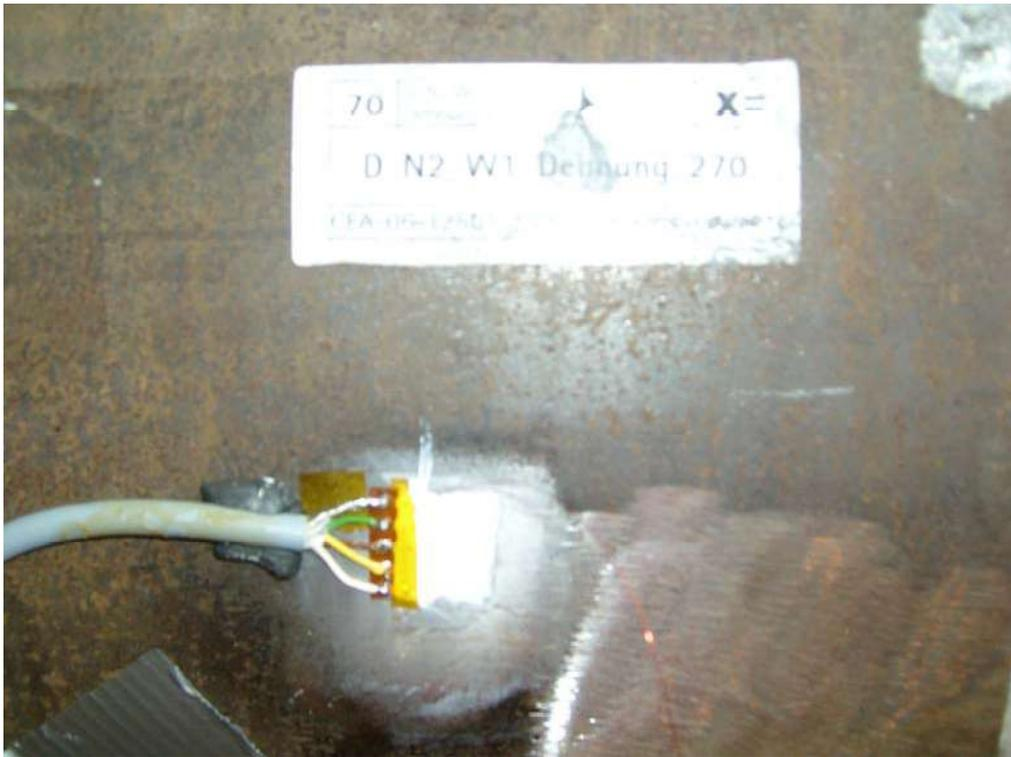
Abbildung 3: DMS Verkabelt und abgedeckt
