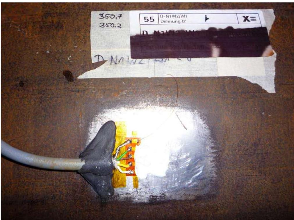
Abbildung 4: DMS verkabelt und abgedeckt
