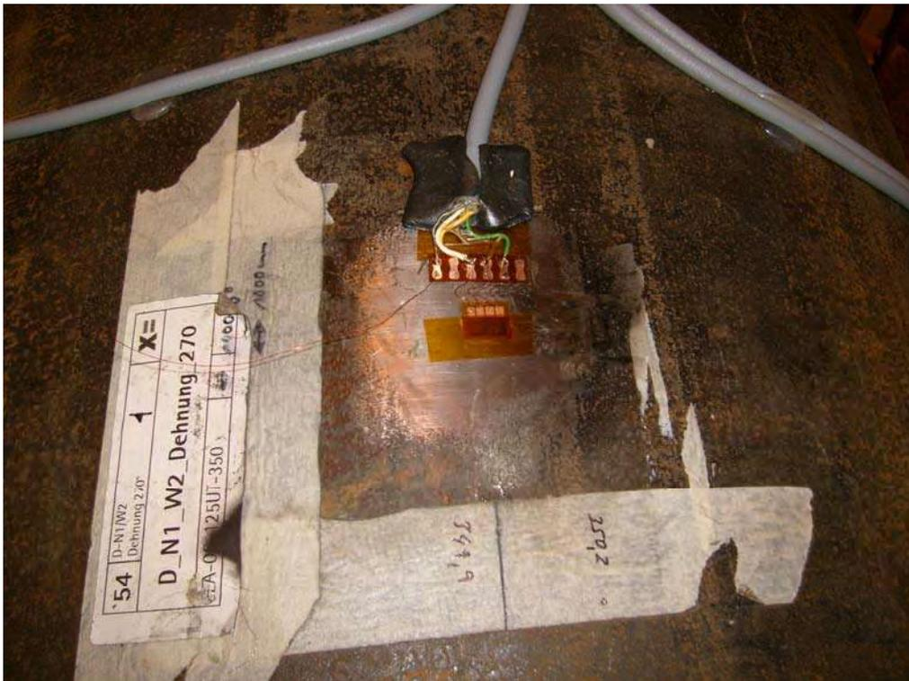
Abbildung 4: DMS verkabelt und abgedeckt
