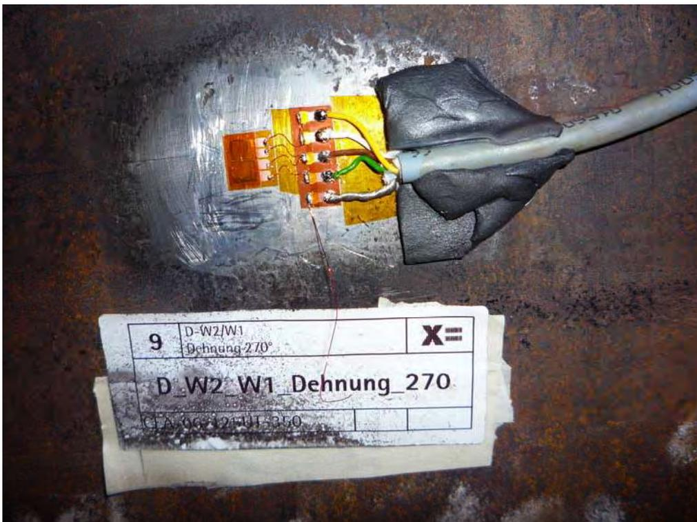
Abbildung 4: DMS verkabelt und abgedeckt
