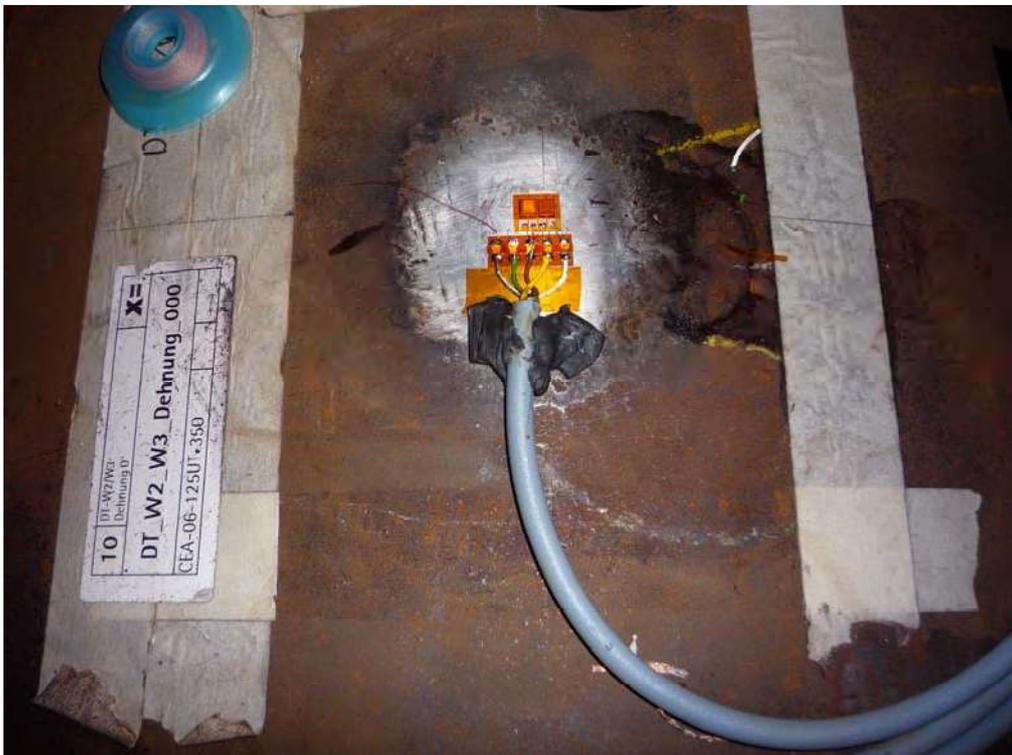
Abbildung 4: DMS verkabelt und abgedeckt
