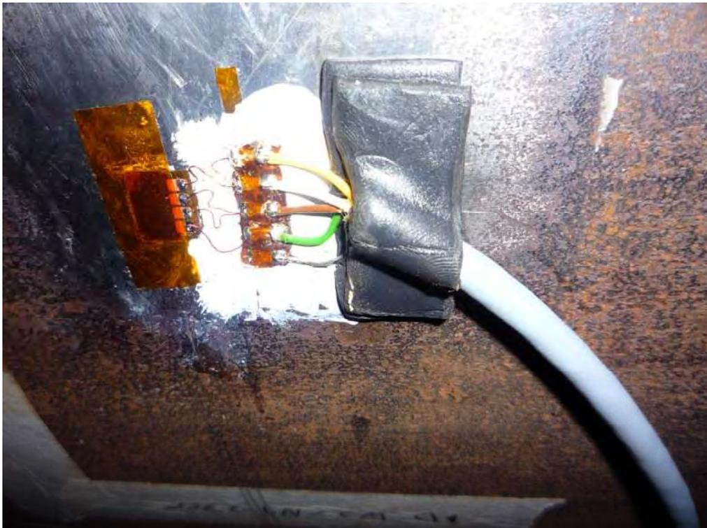
Abbildung 5: DMS verkabelt und abgedeckt
