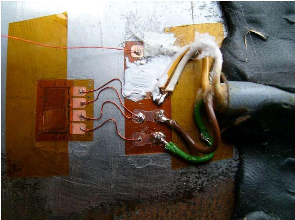
Abbildung 5: DMS verkabelt und abgedeckt
