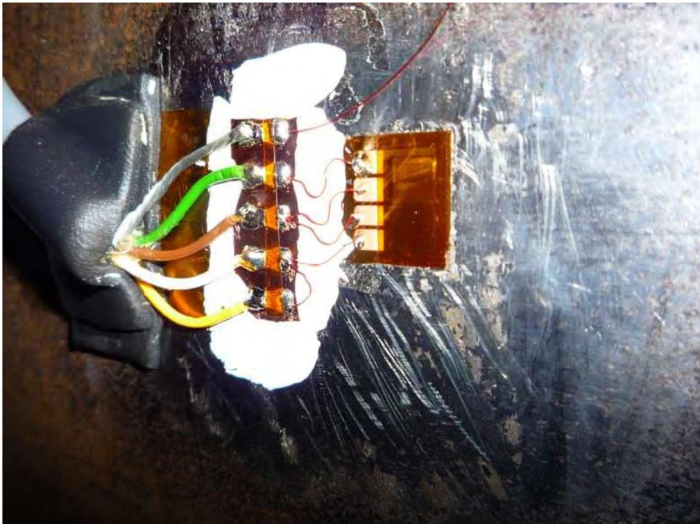
Abbildung 5: DMS verkabelt und abgedeckt
