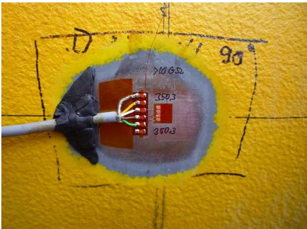
Abbildung 2: DMS verkabelt und abgedeckt
