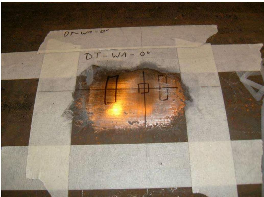
**Abbildung 2: DMS-Position angeschliffen**
