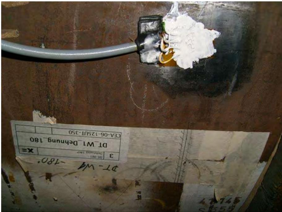
Abbildung 4: DMS verkabelt und abgedeckt
