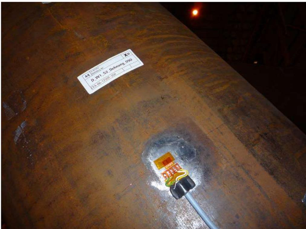
**Abbildung 4: DMS verkabelt und abgedeckt**
