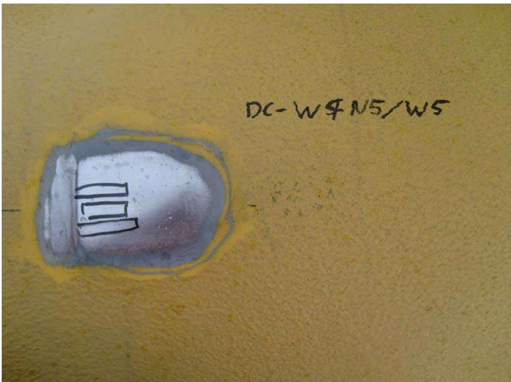
**Abbildung 2: DMS-Position angezeichnet und angeschliffen**
