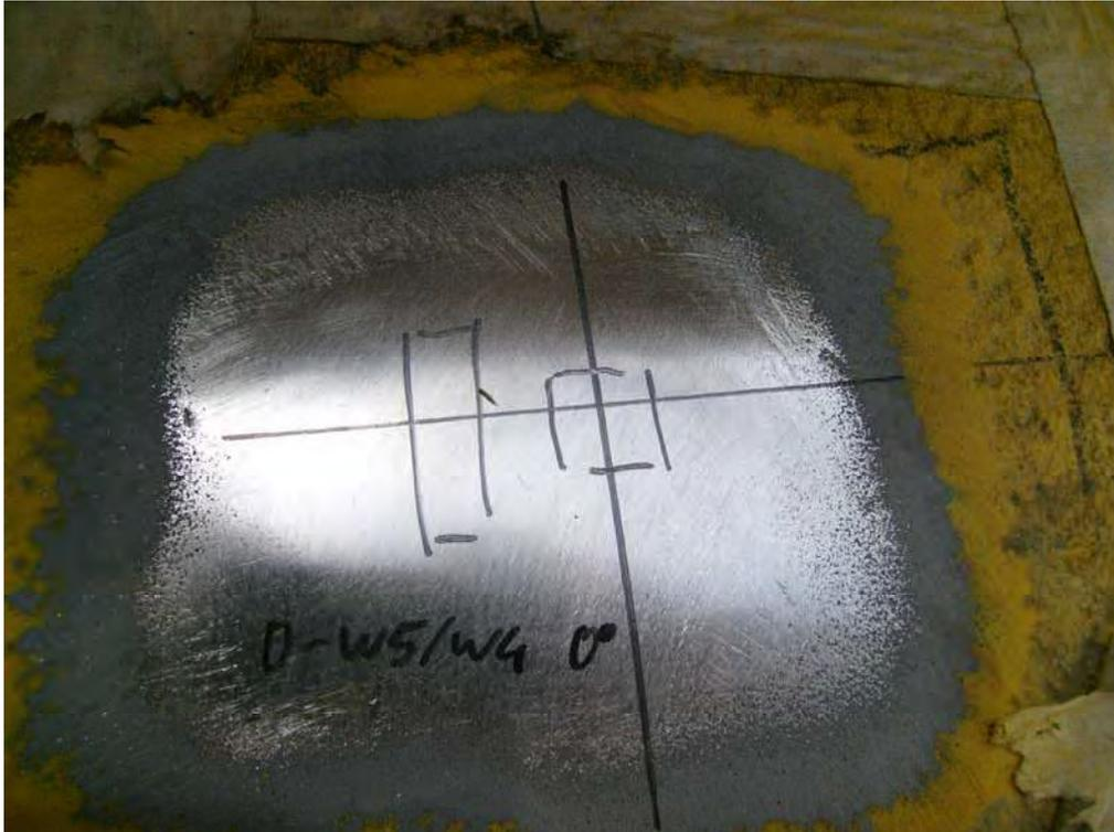
Abbildung 1 DMS-Position angeschliffen
