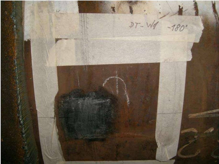
Abbildung 2: DMS-Position angeschliffen
