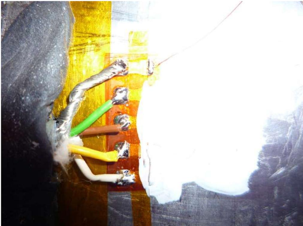
Abbildung 5: DMS verkabelt und abgedeckt
