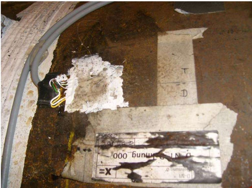
**Abbildung 4: DMS verkabelt und abgedeckt**
