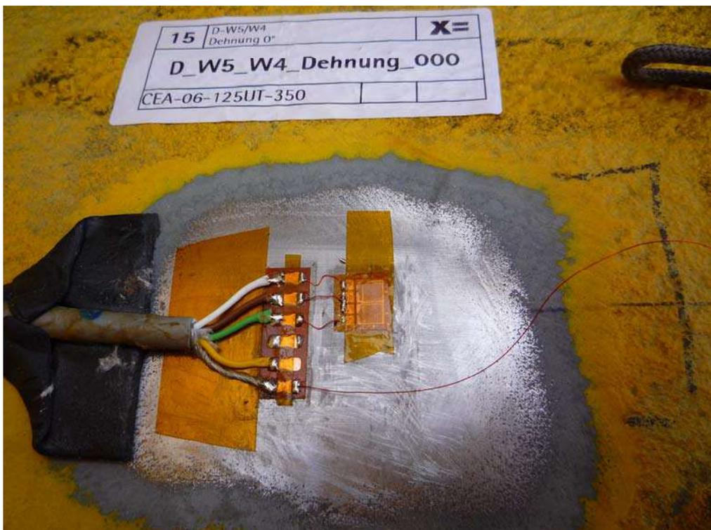
Abbildung 2: DMS verkabelt und abgedeckt
