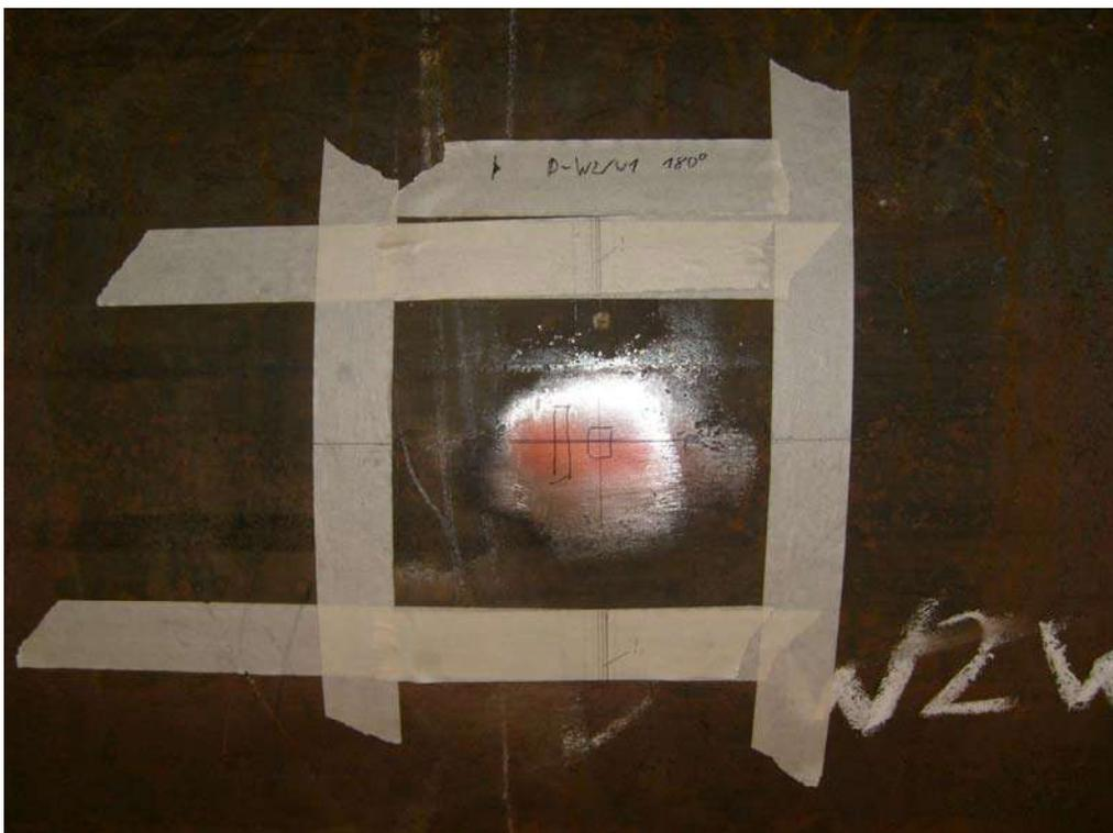
**Abbildung 2: DMS-Position angeschliffen**
