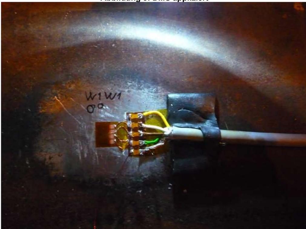
**Abbildung 4: DMS verkabelt und abgedeckt**
