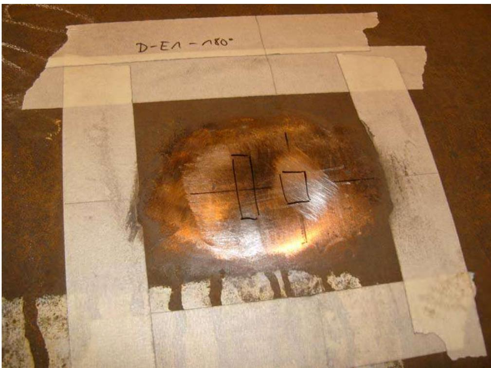
**Abbildung 2: DMS-Position angeschliffen**
