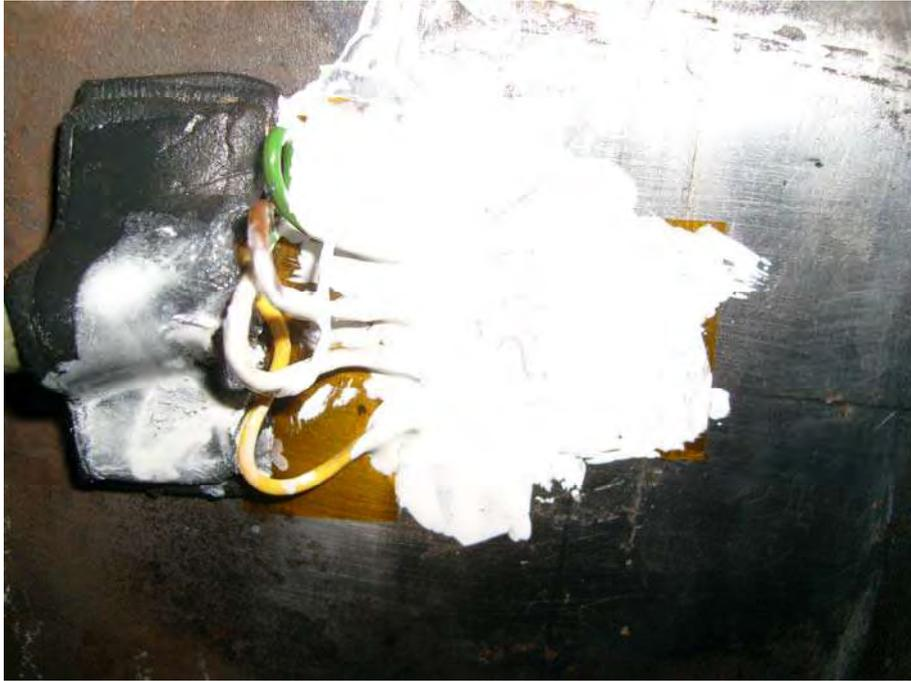
Abbildung 5: DMS verkabelt und abgedeckt
