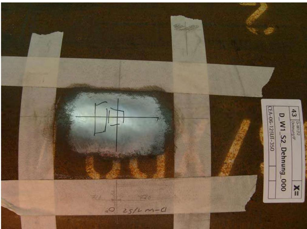
Abbildung 2: DMS-Position angeschliffen
