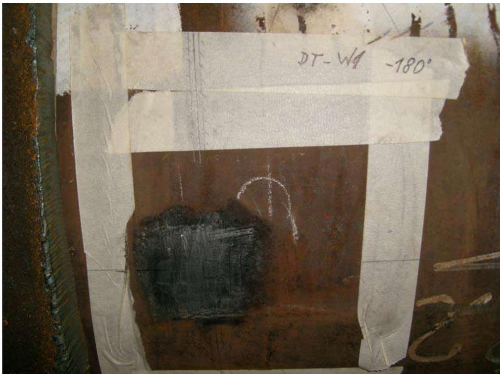
**Abbildung 2: DMS-Position angeschliffen**
