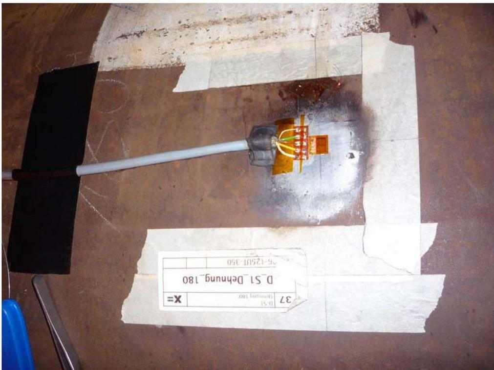
Abbildung 4: DMS verkabelt und abgedeckt
