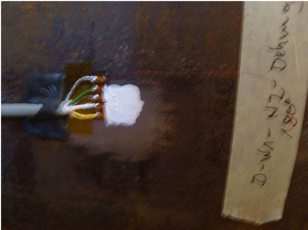
Abbildung 3: DMS verkabelt und abgedeckt
