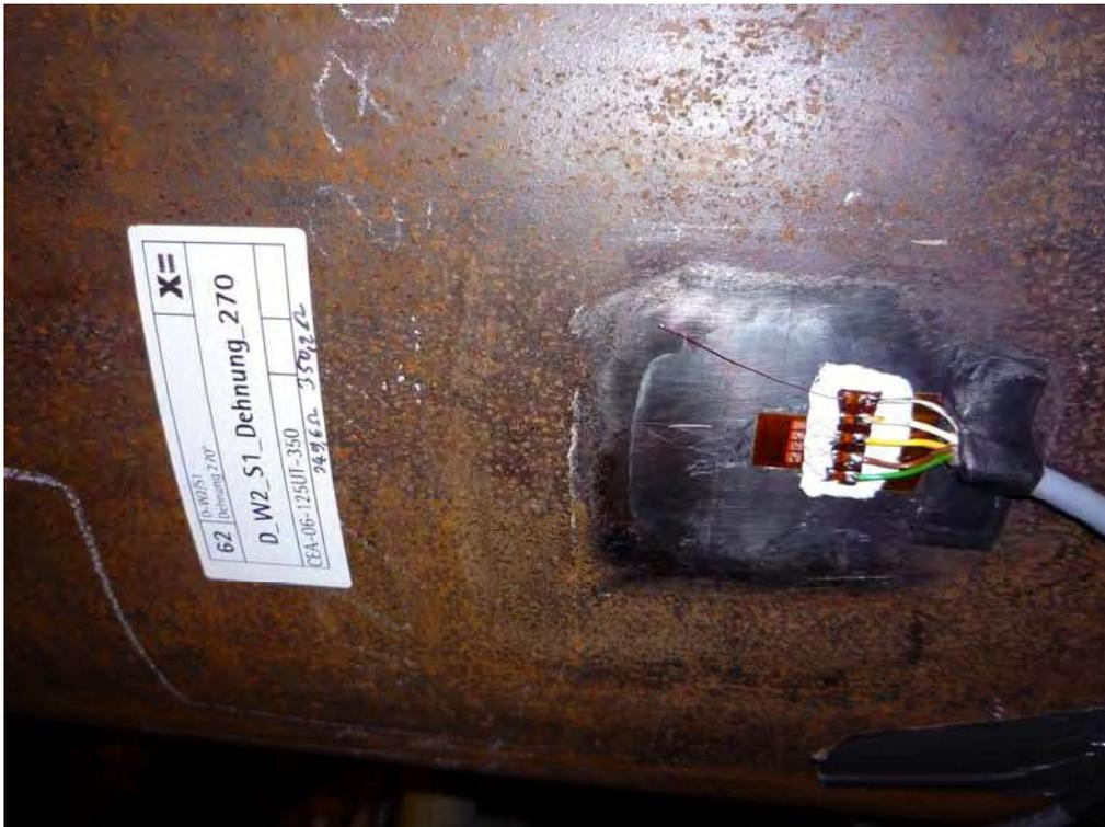
Abbildung 3: DMS verkabelt und abgedeckt
