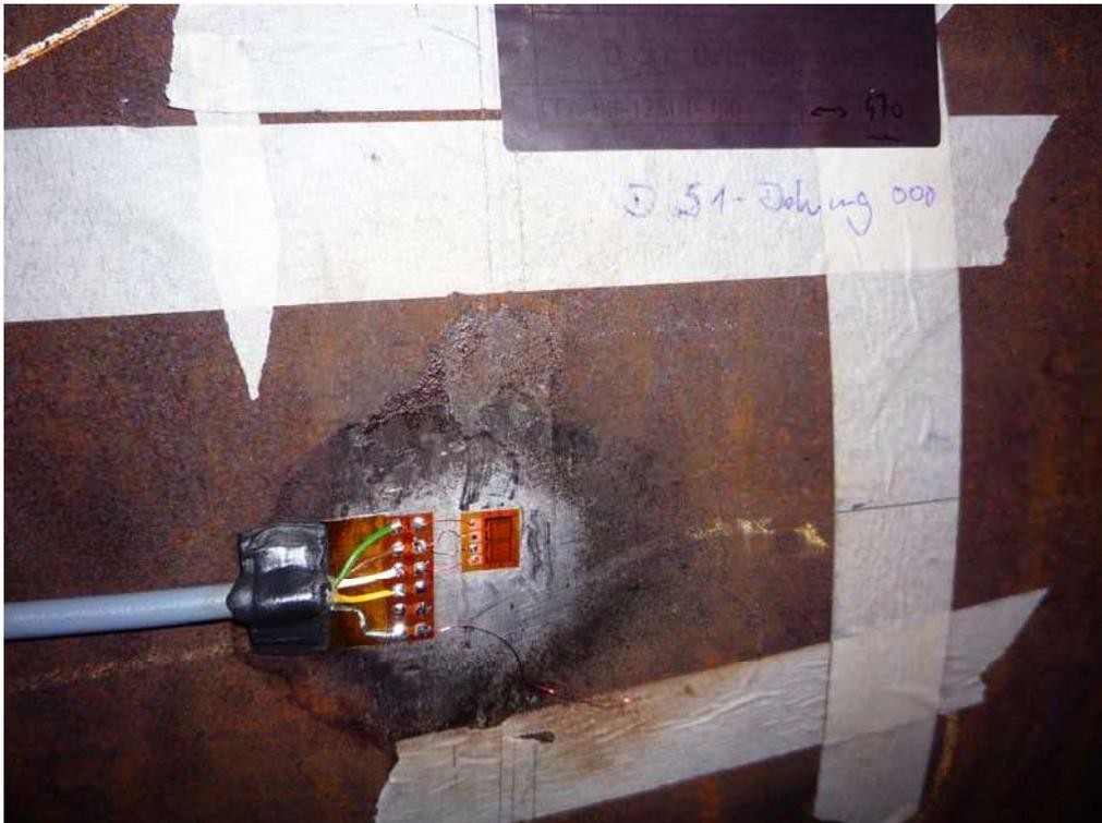
**Abbildung 3: DMS verkabelt und abgedeckt**
