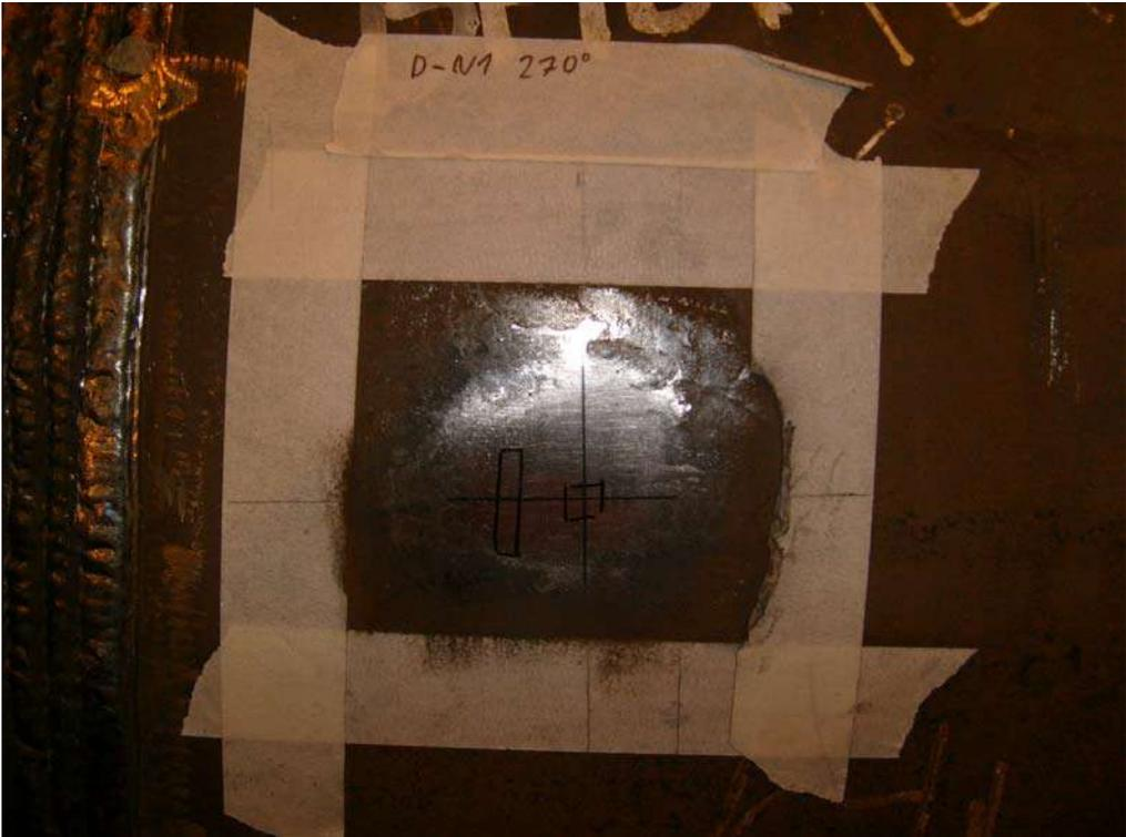
Abbildung 2: DMS-Position angeschliffen
