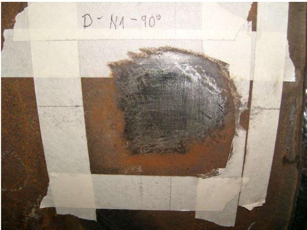
**Abbildung 2: DMS-Position angeschliffen**
