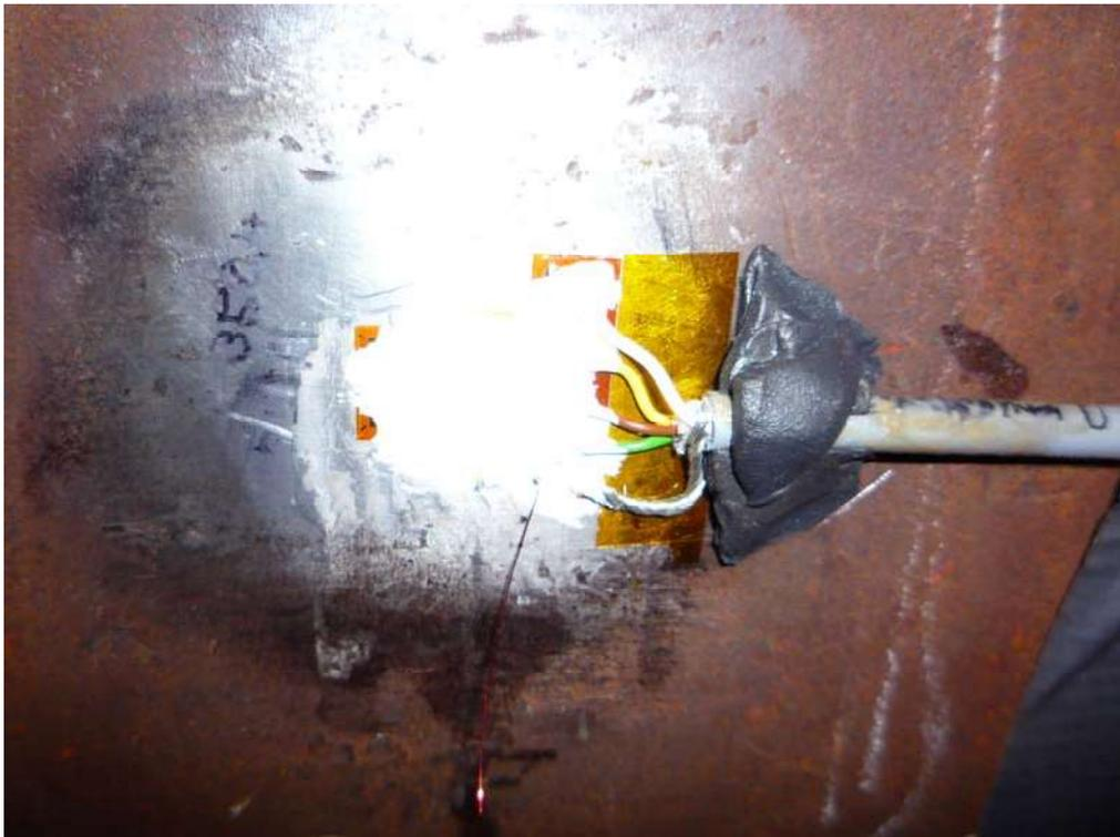
Abbildung 5: DMS verdrahtet und abgedeckt
