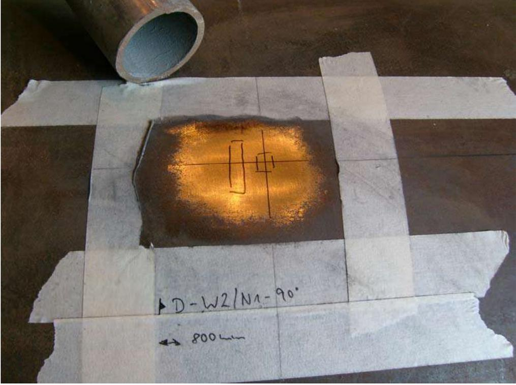
Abbildung 2: DMS-Position angeschliffen
