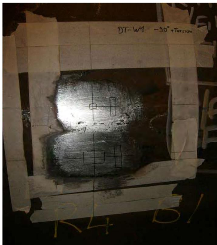
Abbildung 2: DMS-Position angeschliffen
