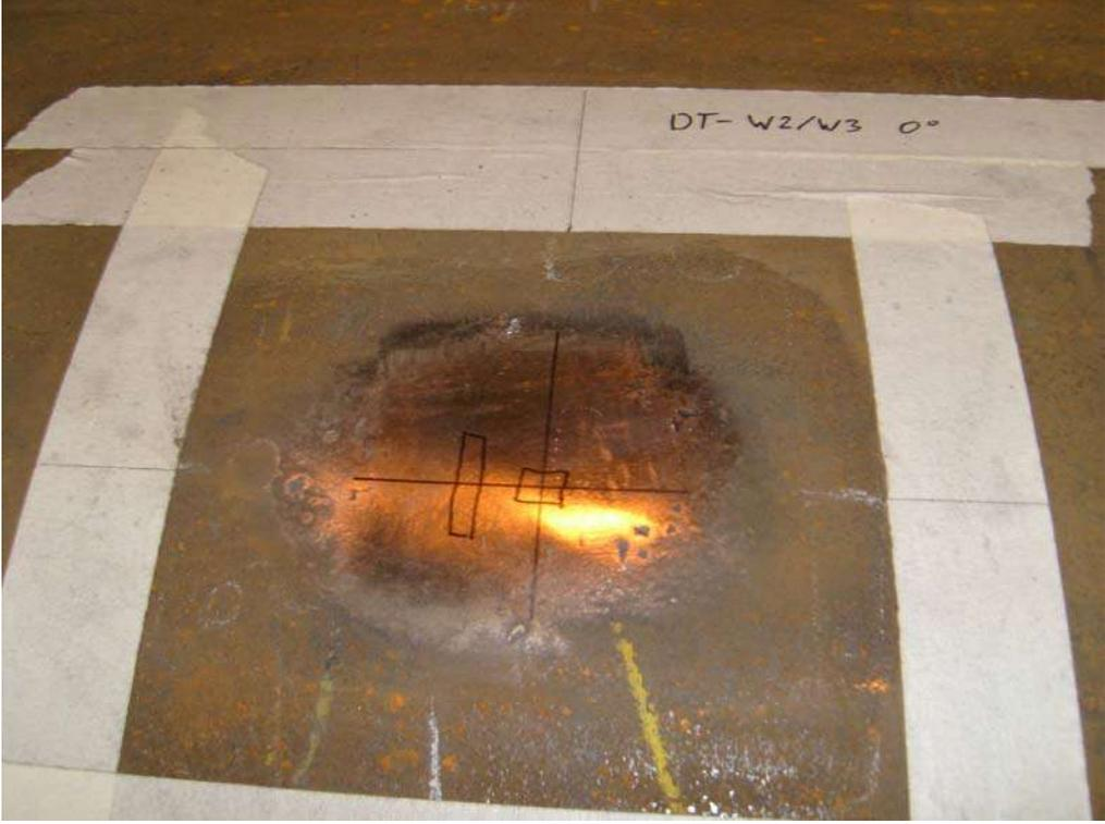
Abbildung 2: DMS-Position angeschliffen
