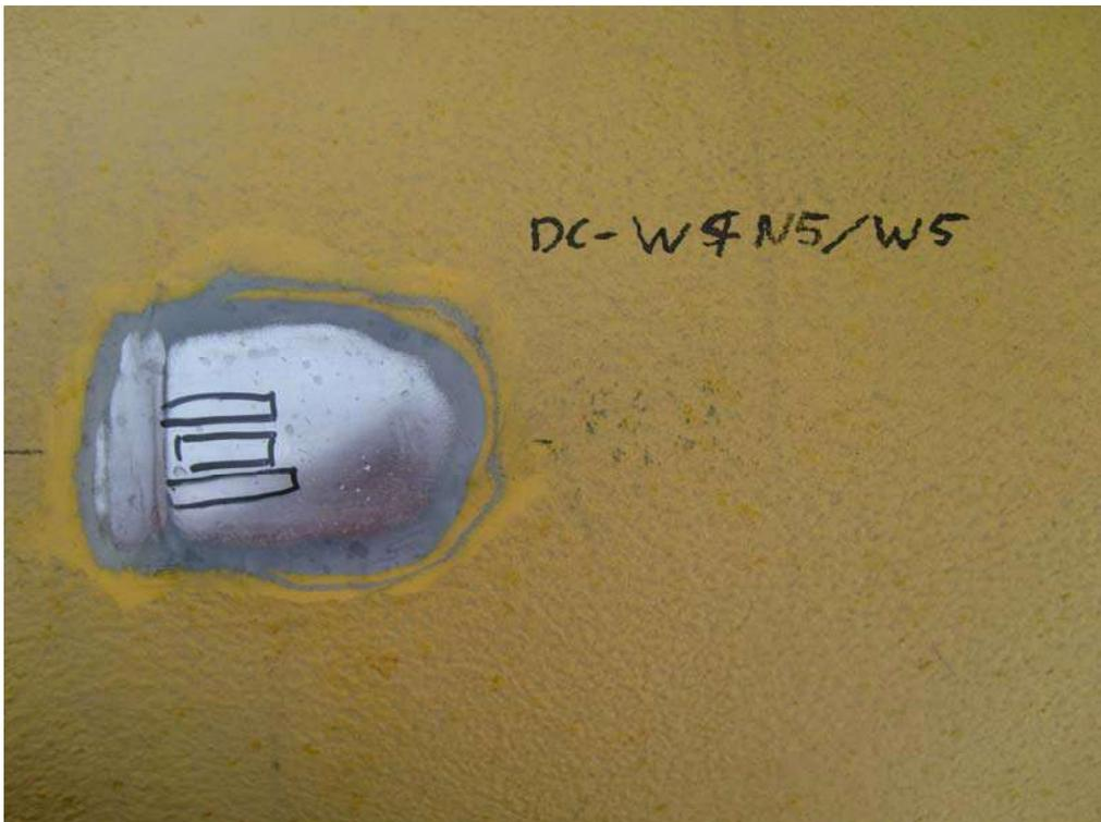
**Abbildung 2: DMS-Position angezeichnet und angeschliffen**
