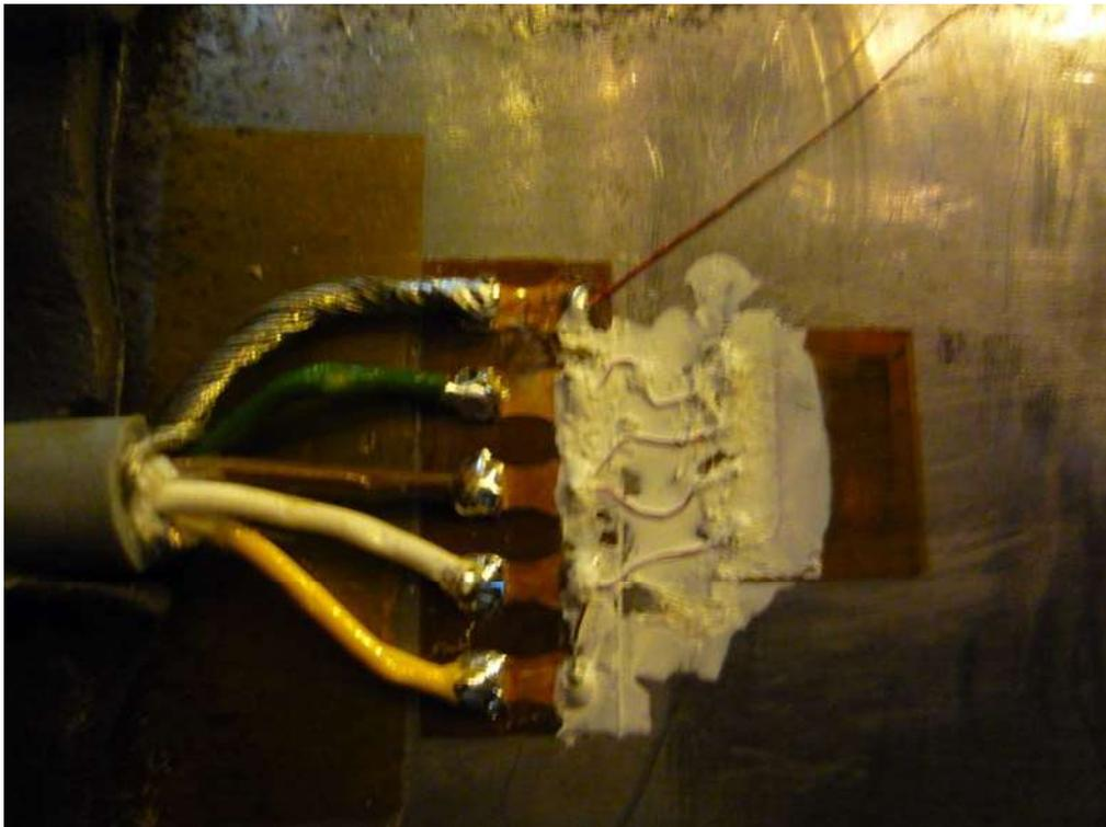
Abbildung 3: DMS verkabelt und abgedeckt
