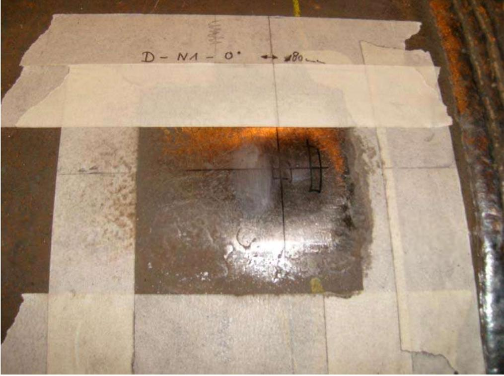
Abbildung 2: DMS-Position angeschliffen
