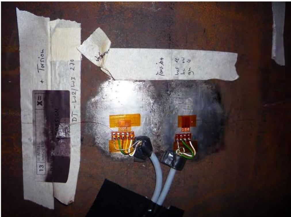
Abbildung 4: DMS verkabelt und abgedeckt
