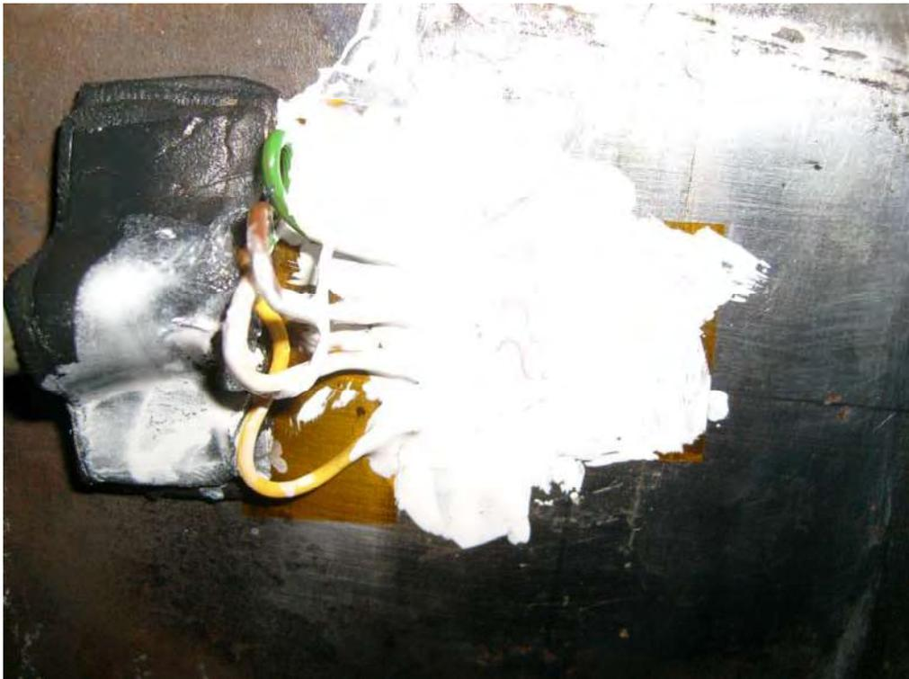
Abbildung 5: DMS verkabelt und abgedeckt
