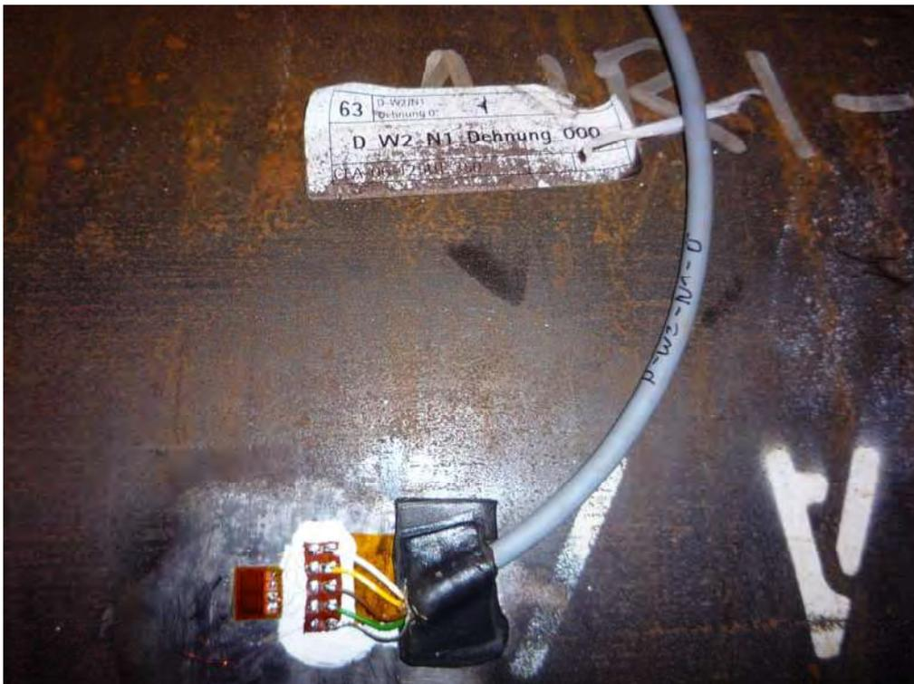
Abbildung 4: DMS verkabelt und abgedeckt
