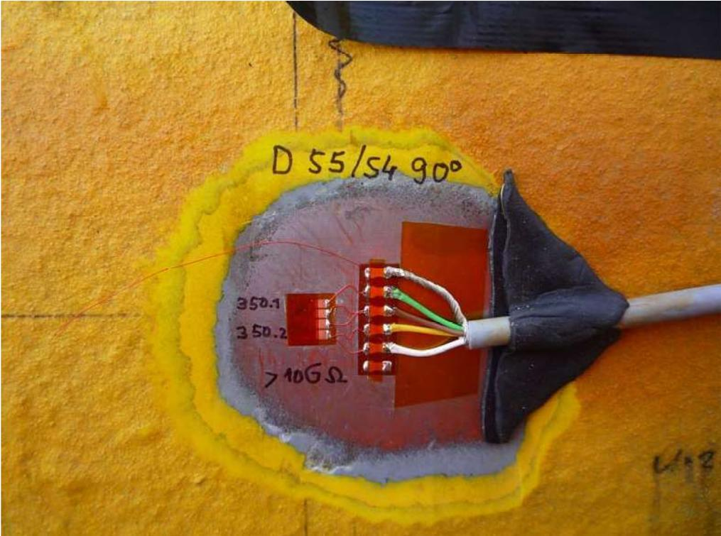
Abbildung 2: DMS verkabelt und abgedeckt
