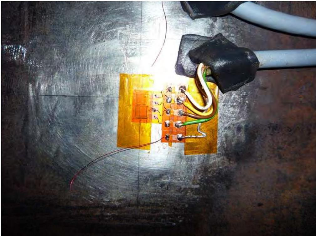
Abbildung 5: DMS verkabelt und abgedeckt
