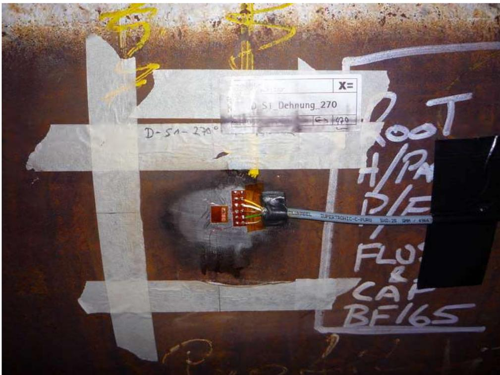
Abbildung 4: DMS verkabelt und abgedeckt
