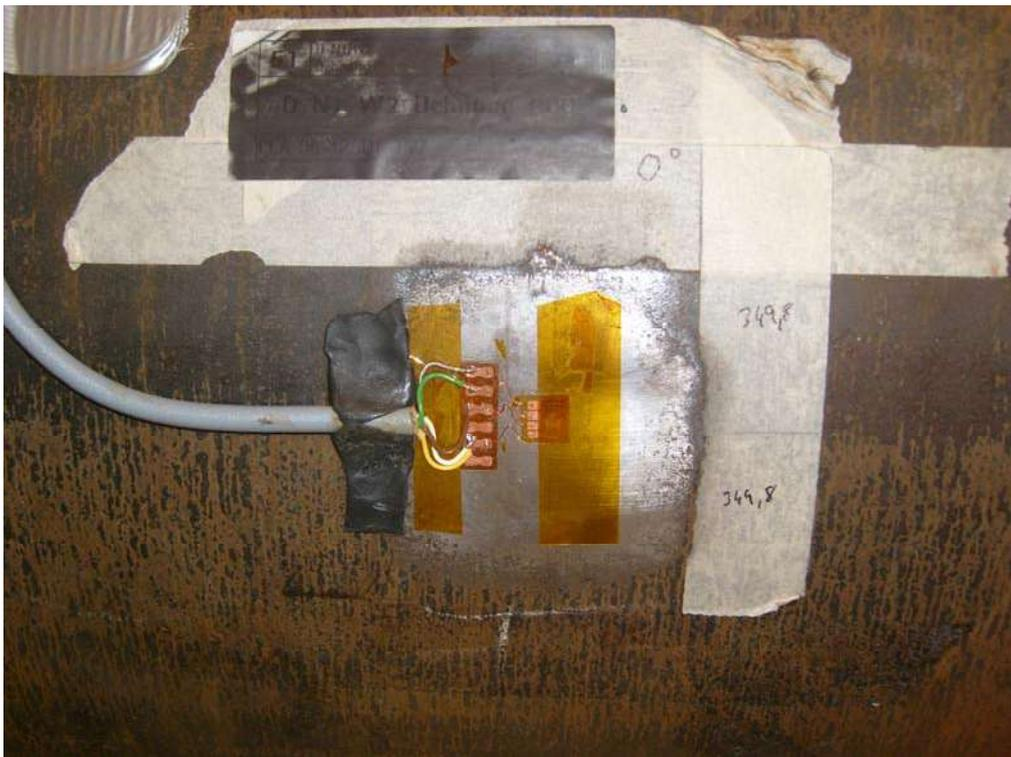
**Abbildung 4: DMS verkabelt und abgedeckt**
