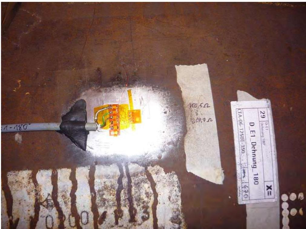
Abbildung 4: DMS verkabelt und abgedeckt
