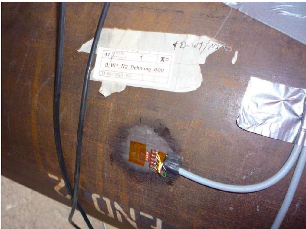
Abbildung 4: DMS verkabelt und abgedeckt
