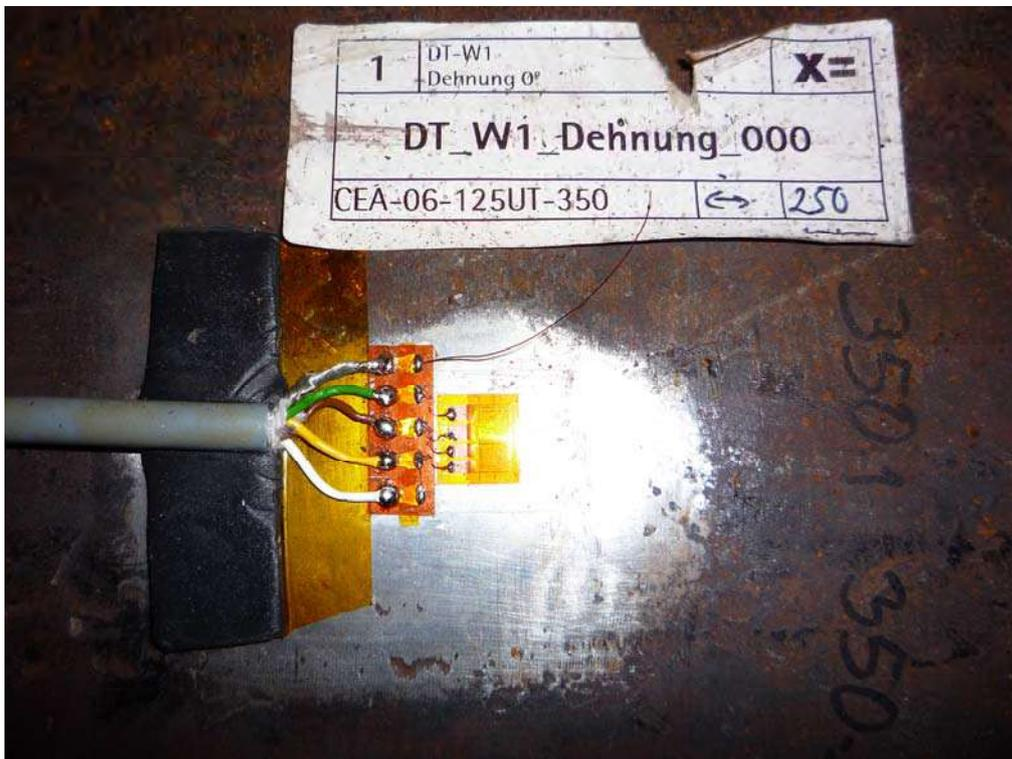
Abbildung 4: DMS verkabelt und abgedeckt
