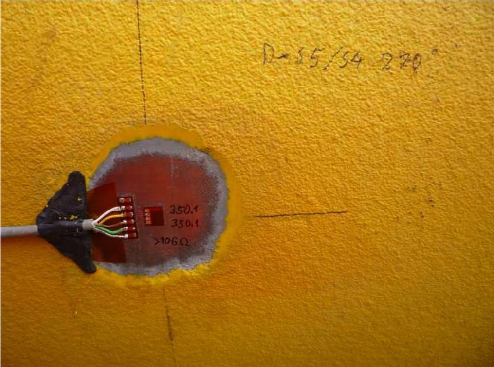
Abbildung 2: DMS verkabelt und abgedeckt
