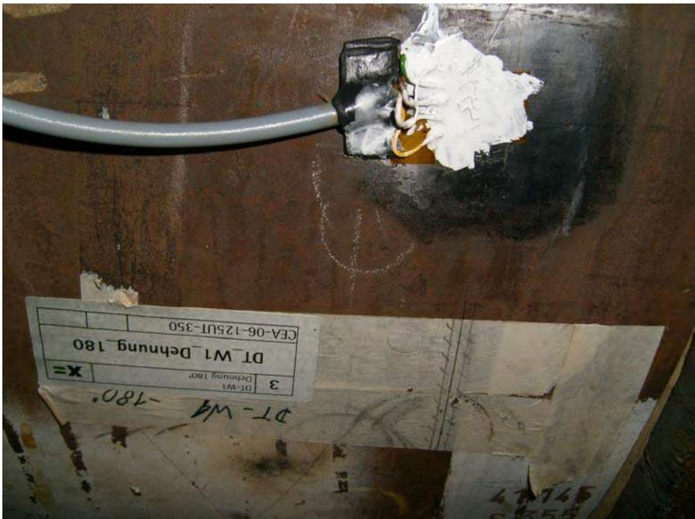
Abbildung 4: DMS verkabelt und abgedeckt
