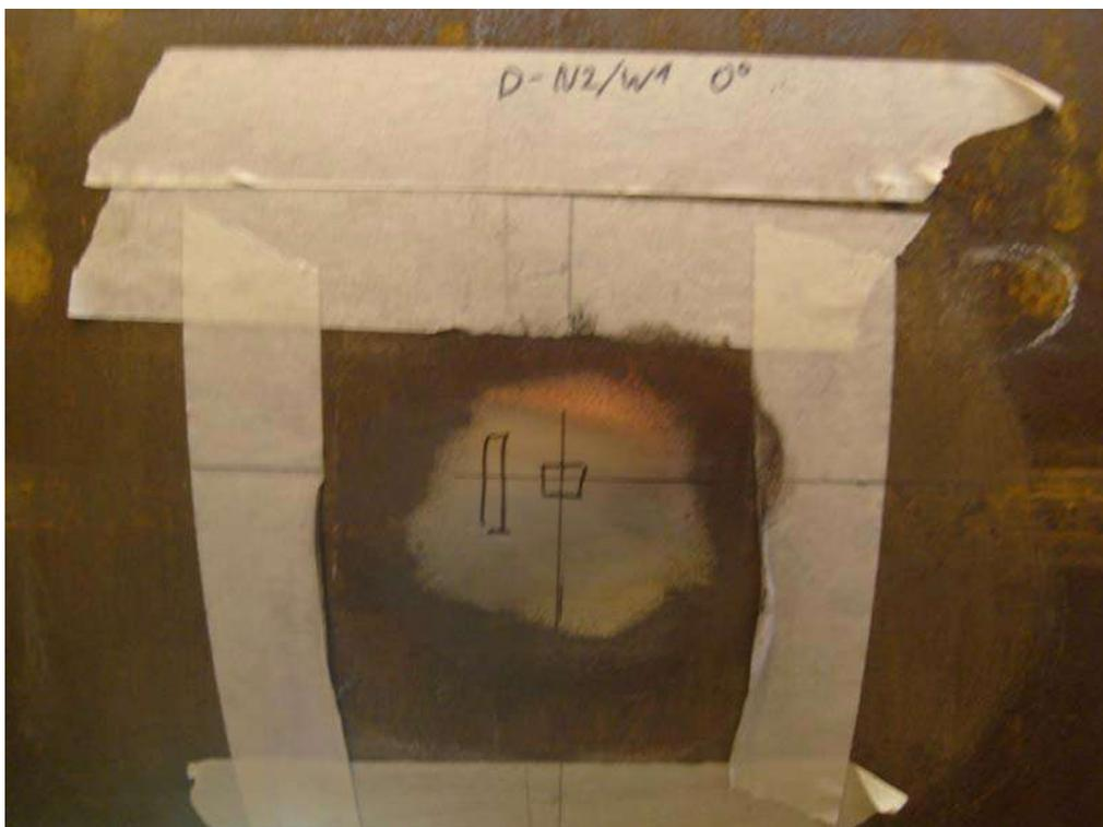
**Abbildung 2: DMS-Position angeschliffen**
