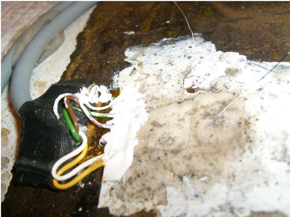
Abbildung 5: DMS verkabelt und abgedeckt
