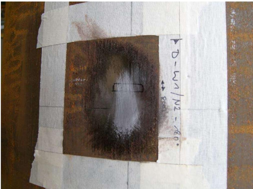
Abbildung 2: DMS-Position angeschliffen
