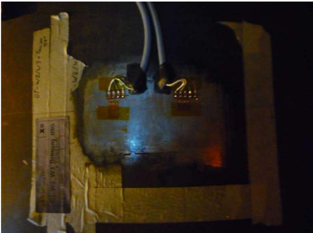
**Abbildung 4: DMS verkabelt und abgedeckt**
