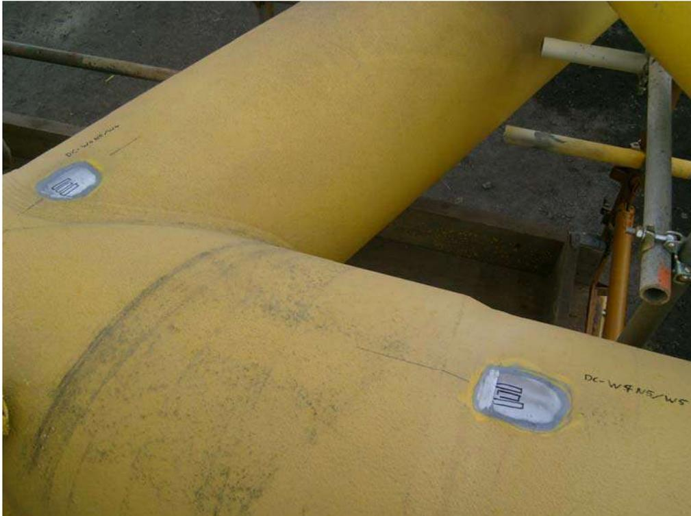
Abbildung 1: DMS-Position angezeichnet und angeschliffen
