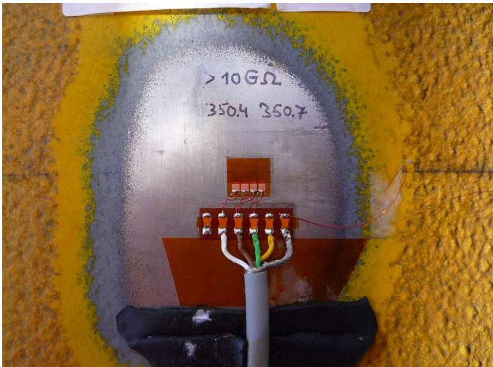
Abbildung 2: DMS verkabelt und abgedeckt
