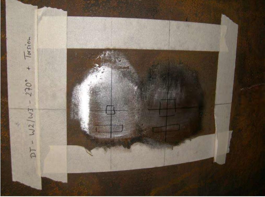
Abbildung 2: DMS-Position angeschliffen
