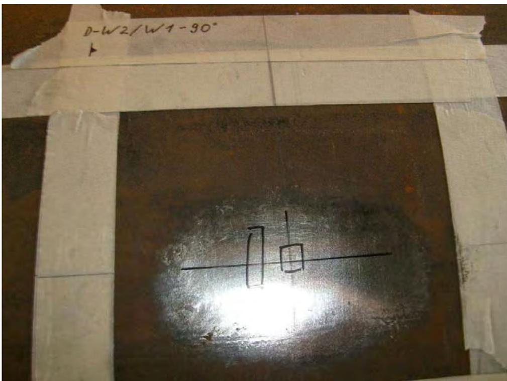
**Abbildung 2: DMS-Position angeschliffen**
