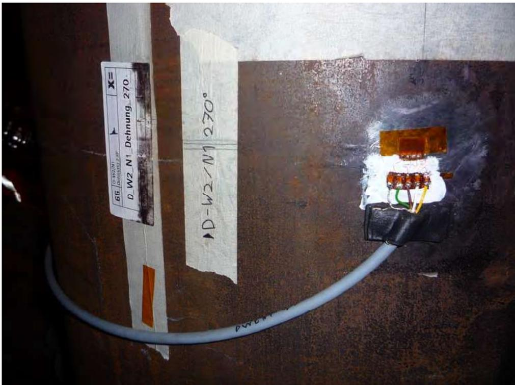
Abbildung 4: DMS verkabelt und abgedeckt
