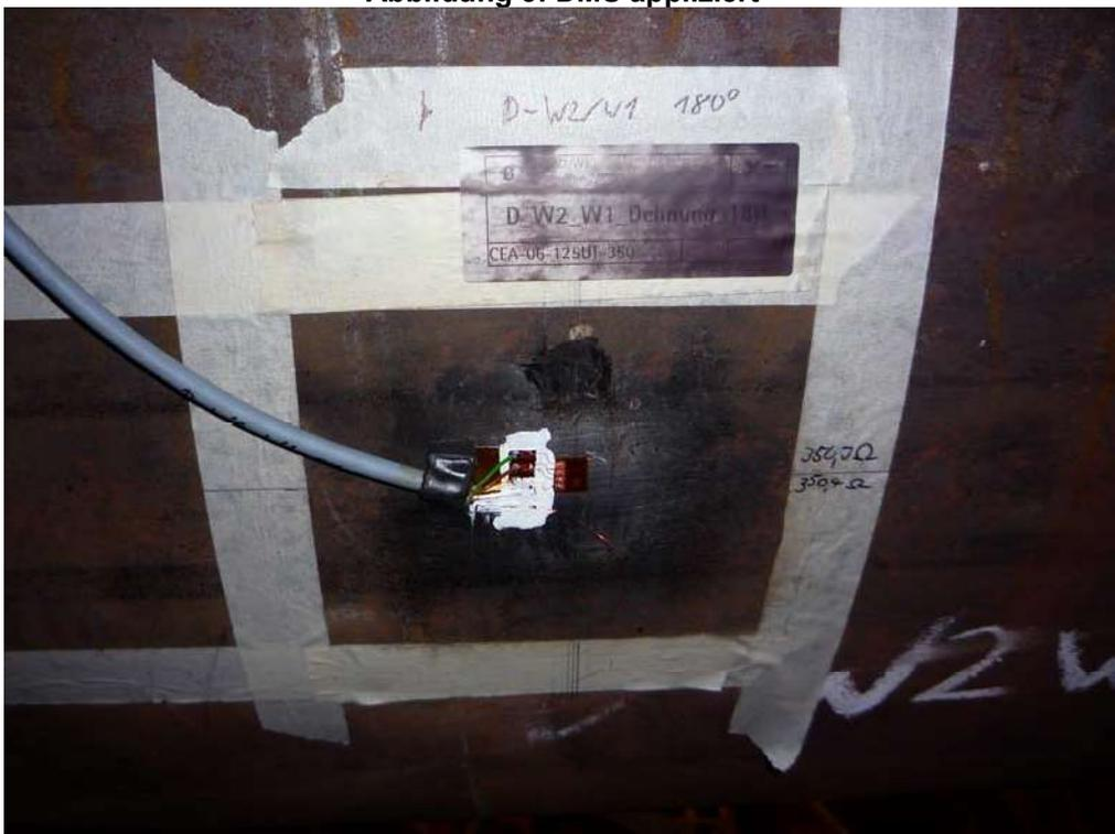
**Abbildung 4: DMS verkabelt und abgedeckt**
