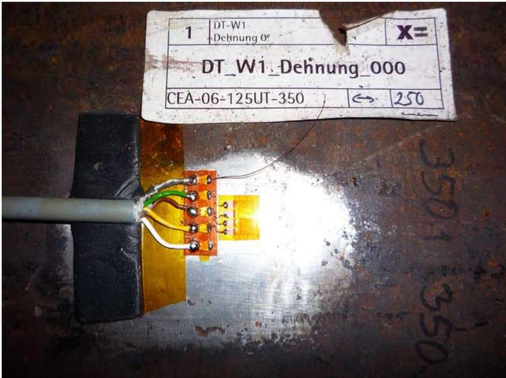
Abbildung 5: DMS verkabelt und abgedeckt
