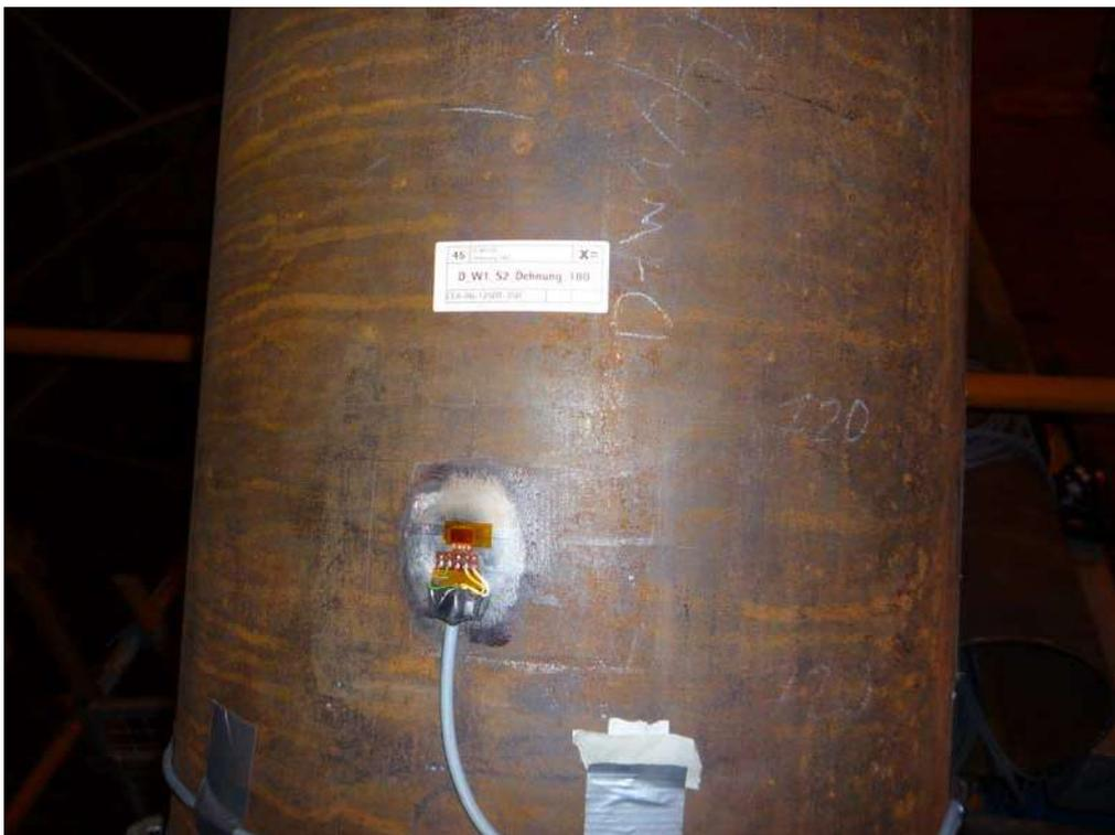
**Abbildung 4: DMS verkabelt und abgedeckt**
