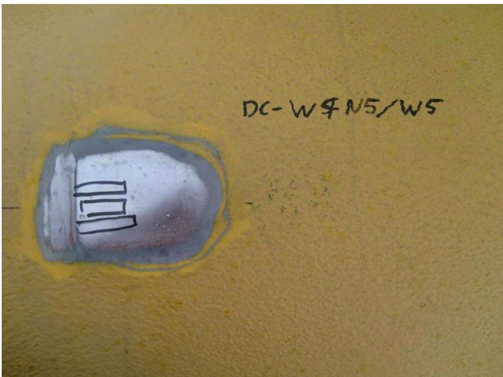
Abbildung 1: DMS-Position angezeichnet und angeschliffen
