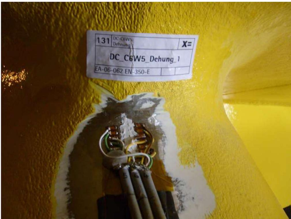
Abbildung 2: DMS verkabelt und abgedeckt
