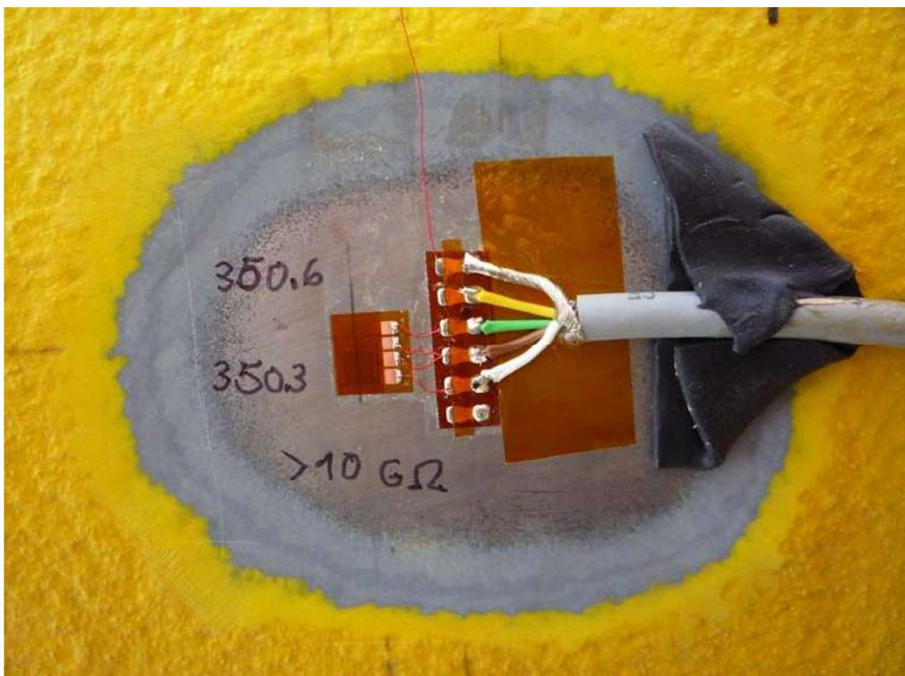
Abbildung 2: DMS verkabelt und abgedeckt
