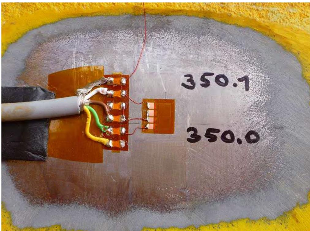
Abbildung 2: DMS verkabelt und abgedeckt
