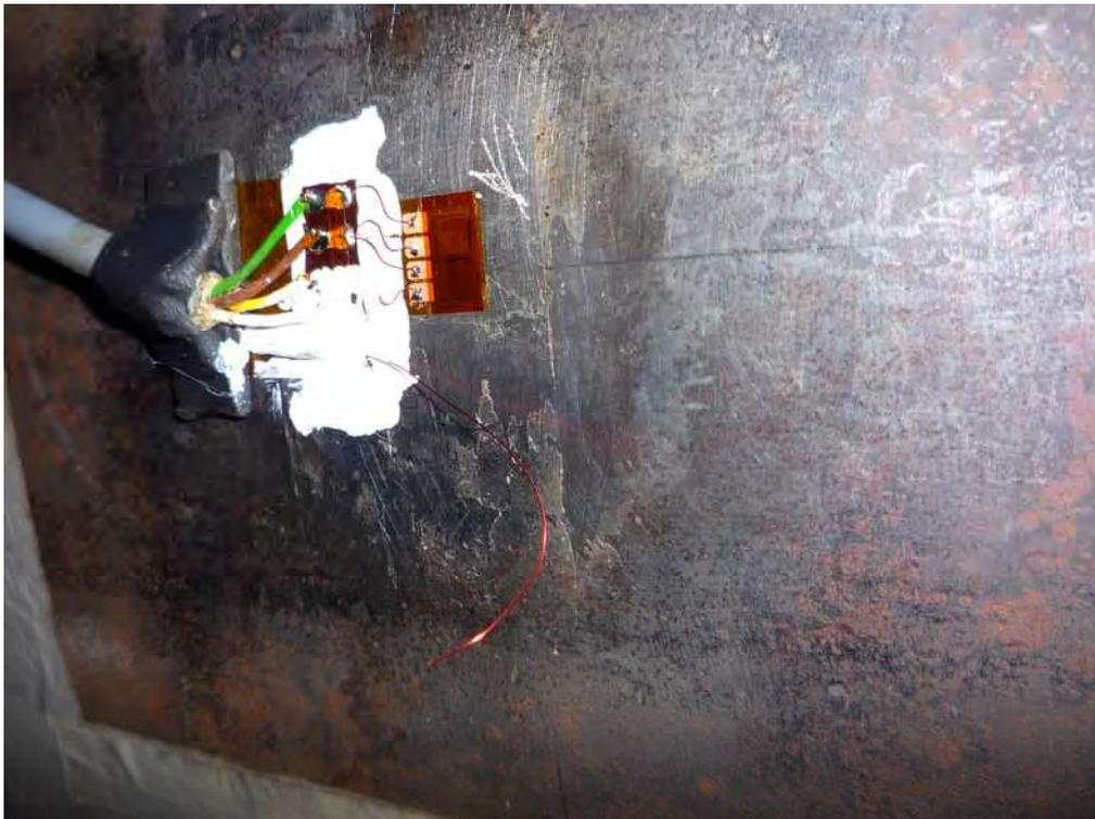
Abbildung 5: DMS verkabelt und abgedeckt
