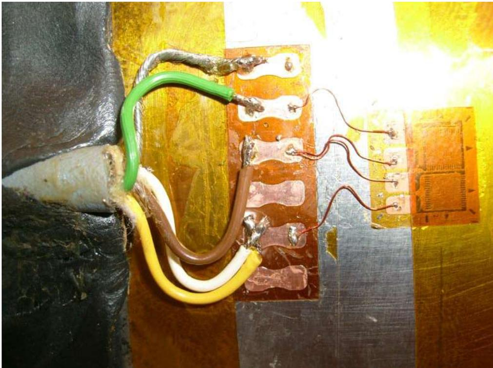
Abbildung 5: DMS verkabelt und abgedeckt
