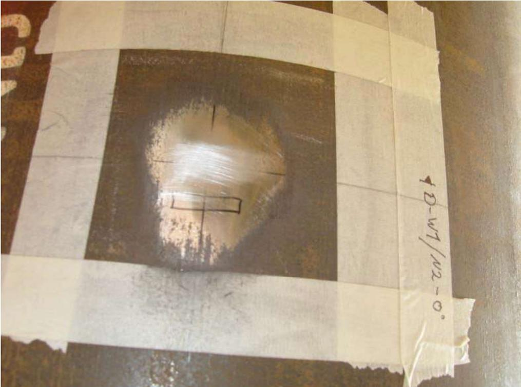
Abbildung 2: DMS-Position angeschliffen
