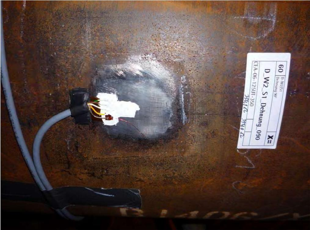
Abbildung 2: DMS verkabelt und abgedeckt
