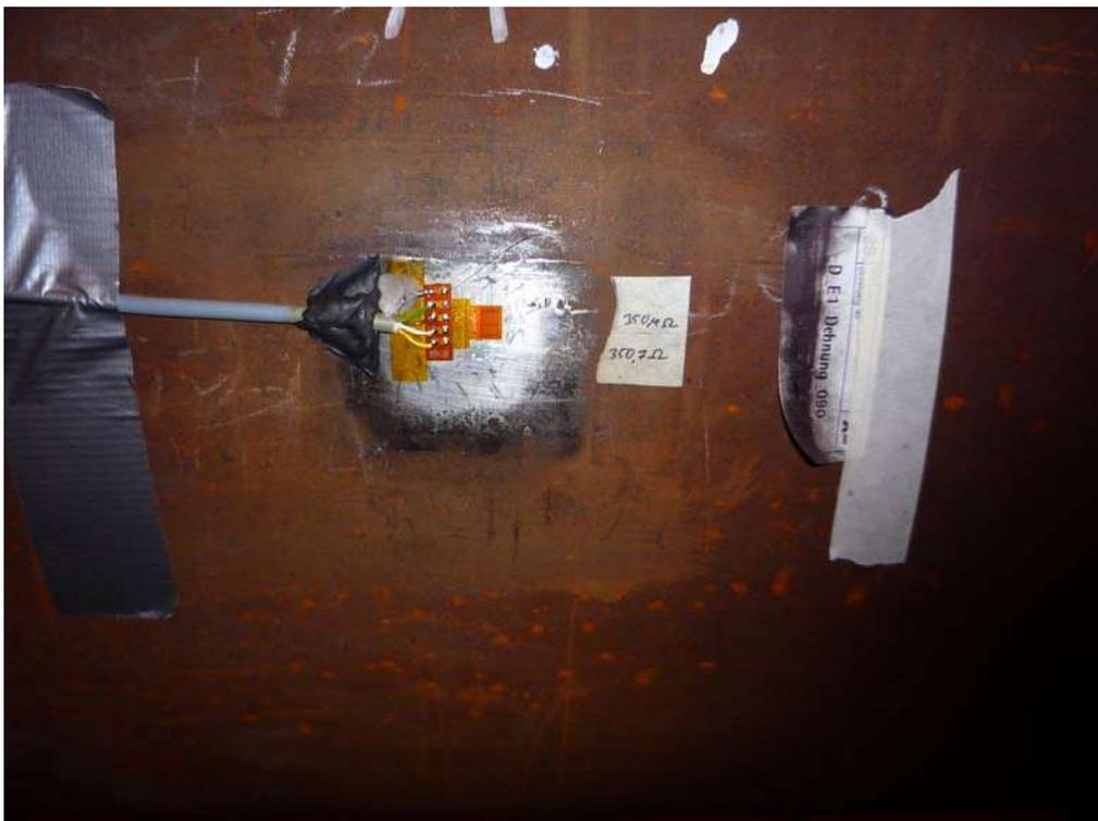
Abbildung 4: DMS verkabelt und abgedeckt
