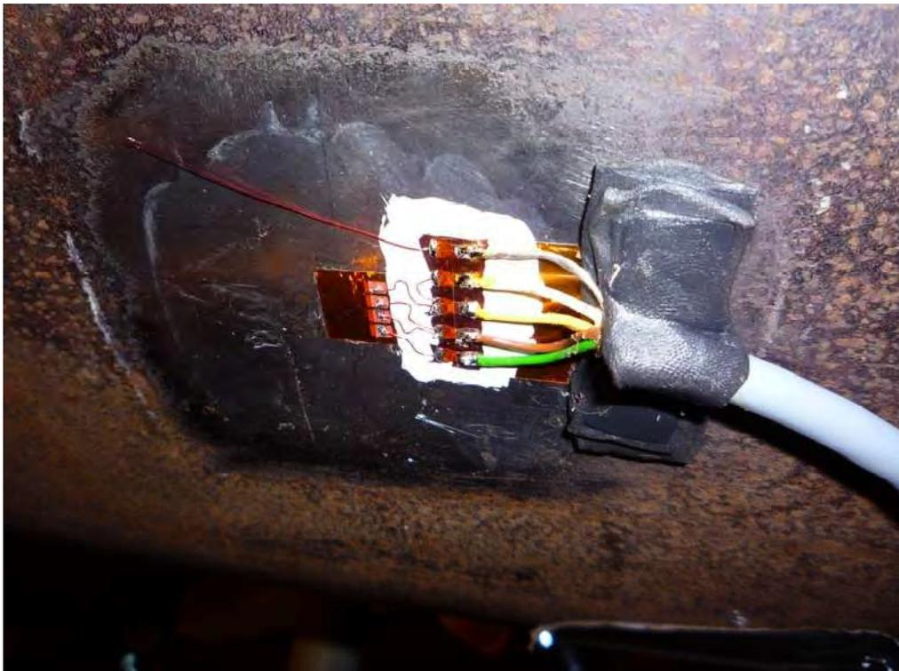
**Abbildung 2: DMS verkabelt und abgedeckt**
