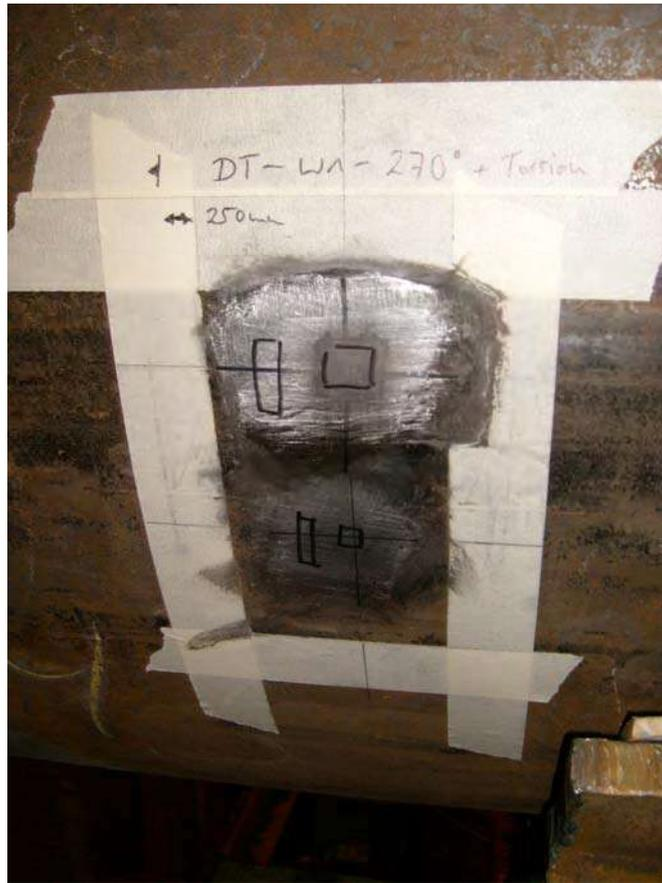
**Abbildung 2: DMS-Position angeschliffen**
