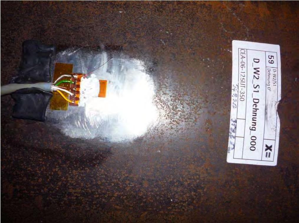
Abbildung 2: DMS verkabelt und abgedeckt
