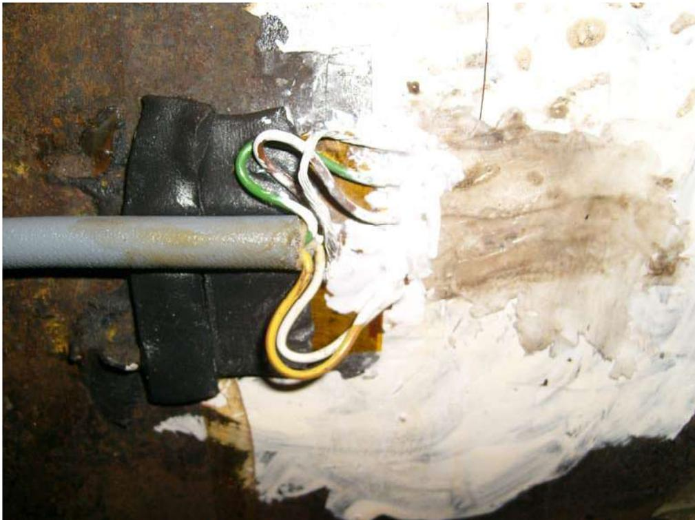
Abbildung 5: DMS verkabelt und abgedeckt
