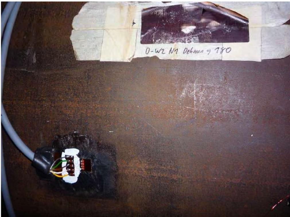
**Abbildung 4: DMS verkabelt und abgedeckt**
