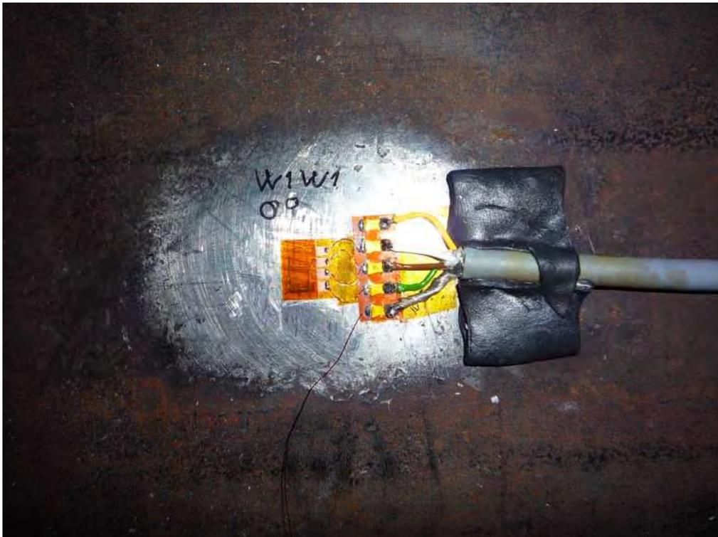
Abbildung 5: DMS verkabelt und abgedeckt
