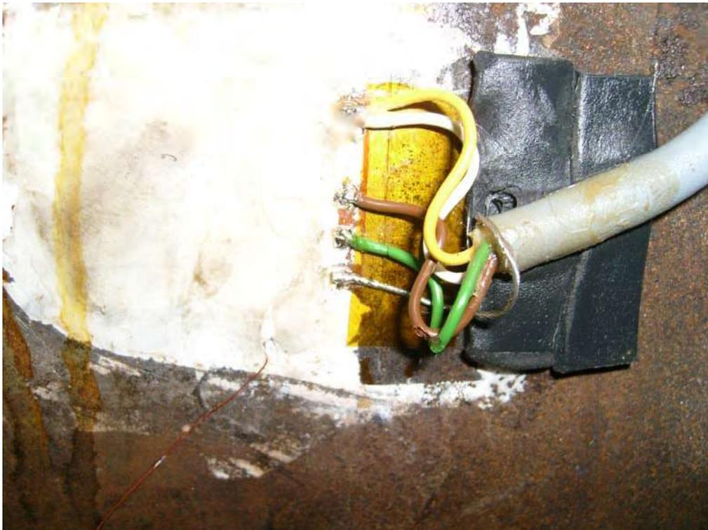
Abbildung 5: DMS verkabelt und abgedeckt
