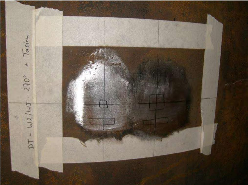
Abbildung 2: DMS-Position angeschliffen
