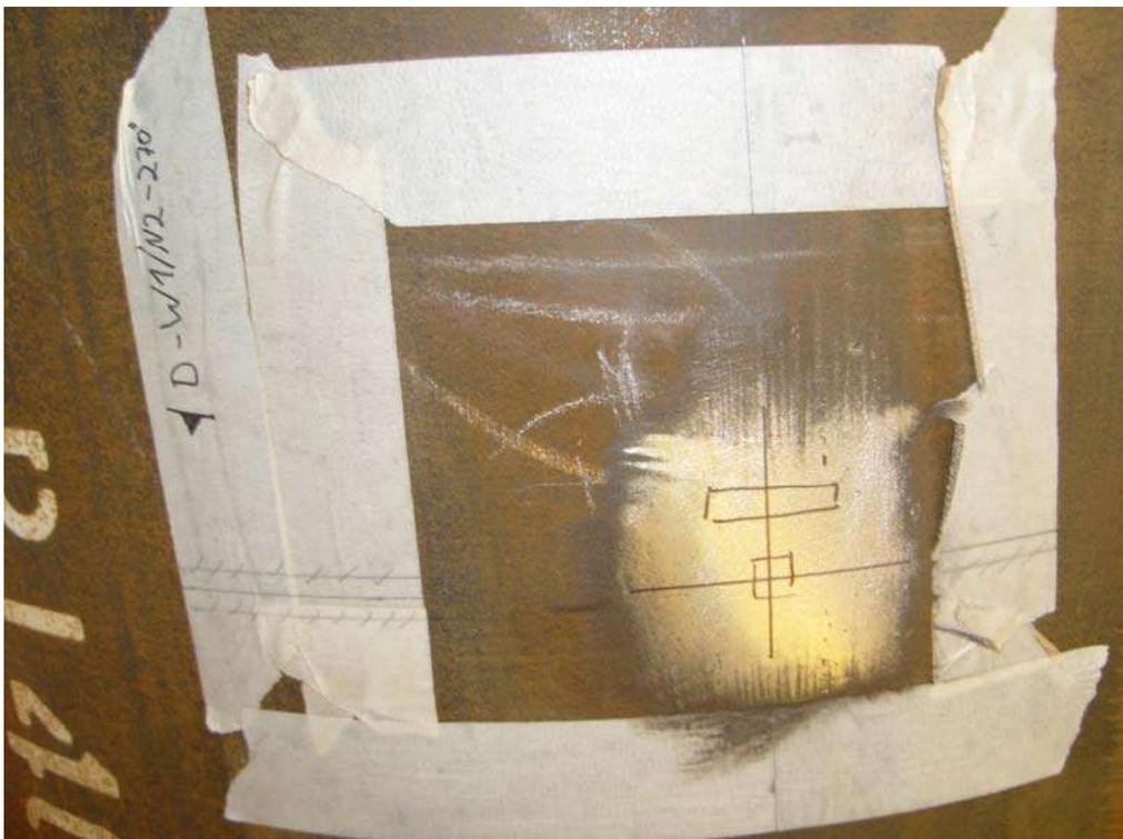
Abbildung 2: DMS-Position angeschliffen
