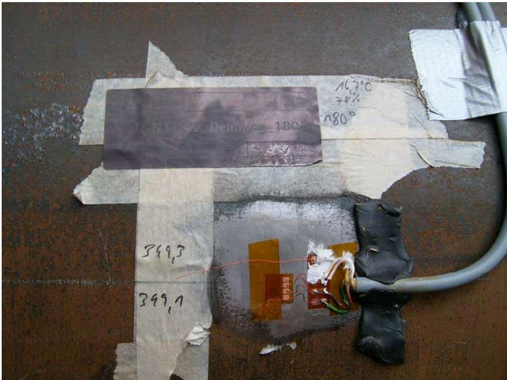
Abbildung 4: DMS verkabelt und abgedeckt
