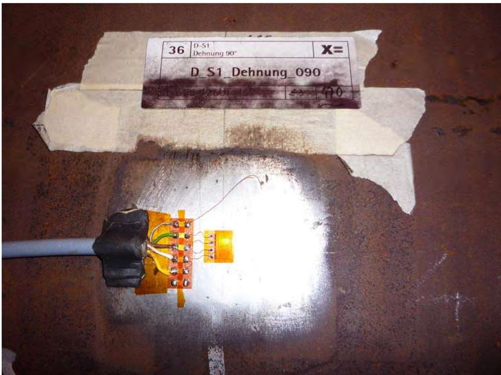
Abbildung 4: DMS verkabelt und abgedeckt
