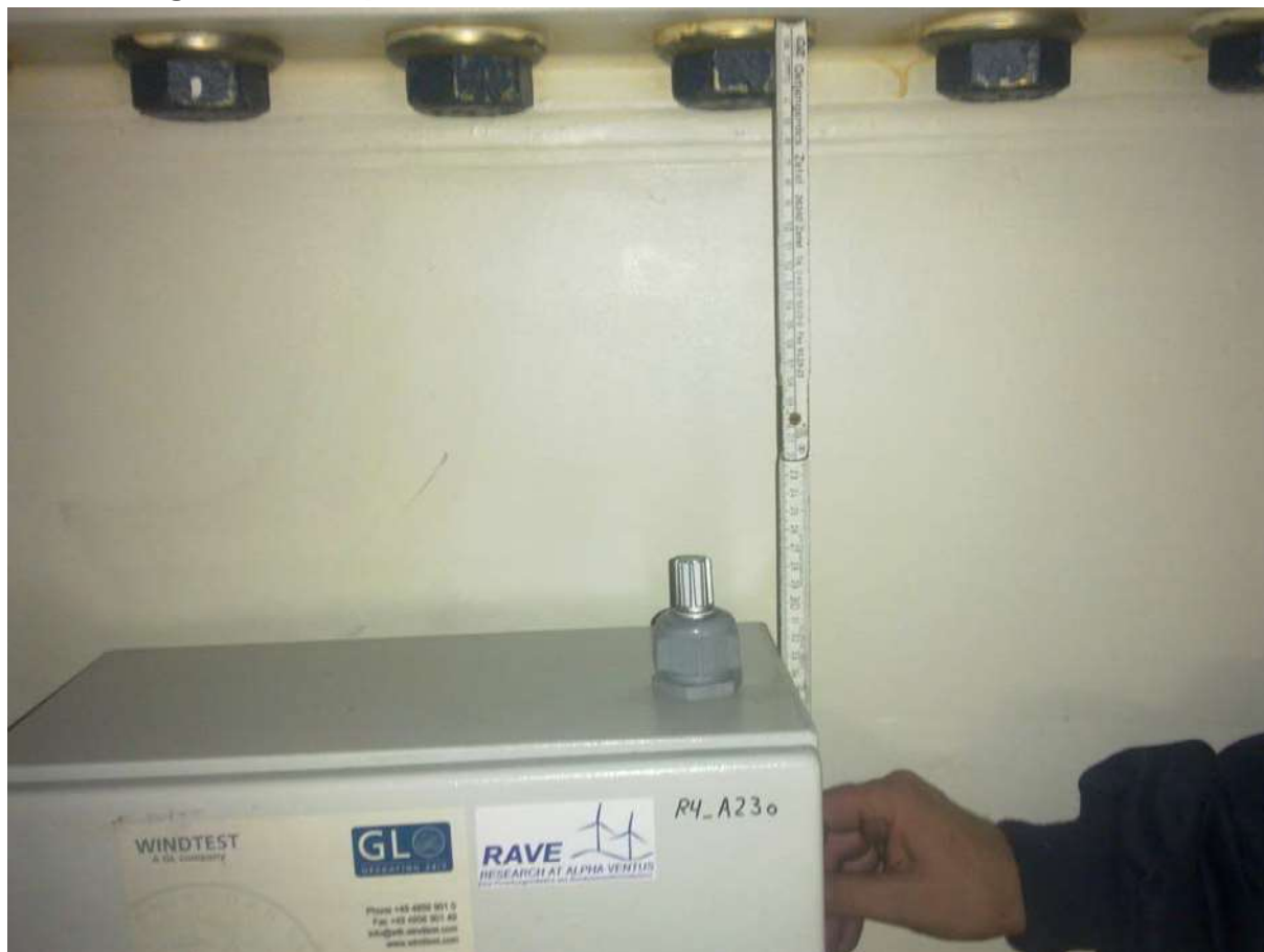
Abbildung 2: Sensorposition unterhalb Flanschekante
