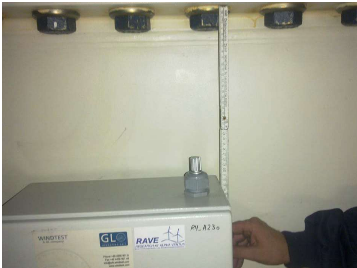
Abbildung 2: Sensorposition unterhalb Flanschekante
