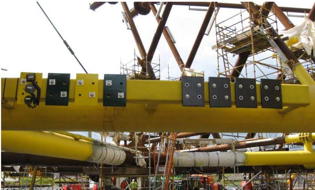
**Abbildung 2: Test-Coupons E.II-IV bis E.II-VIII**
