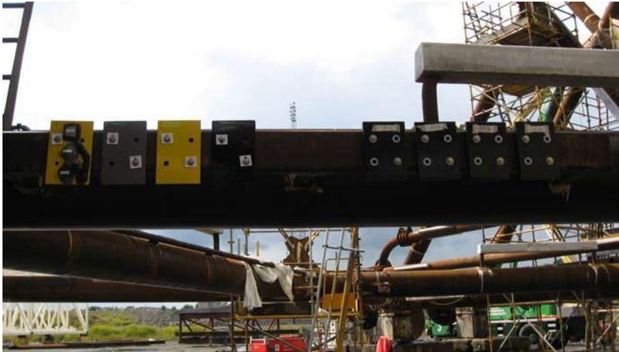
Abbildung 2: Test-Coupons E.I-IV bis E.I-VIII
