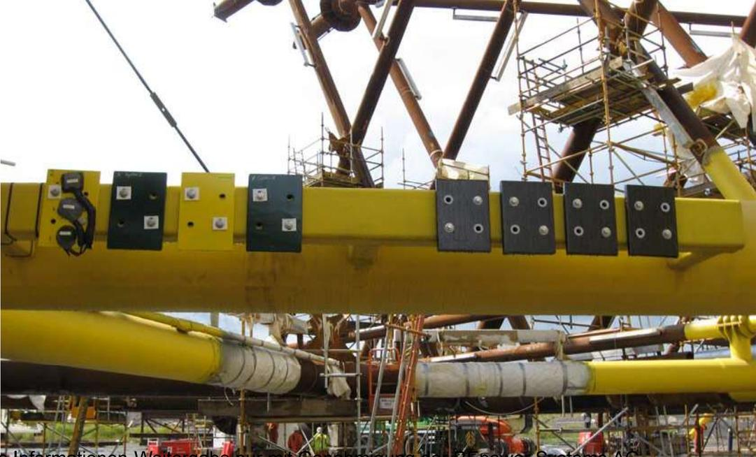
**Abbildung 2: Test-Coupons E.II-IV bis E.II-VIII**
