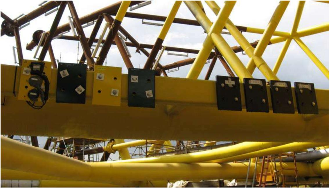
**Abbildung 2: Test-Coupons E.III-IV bis E.III-VIII**
